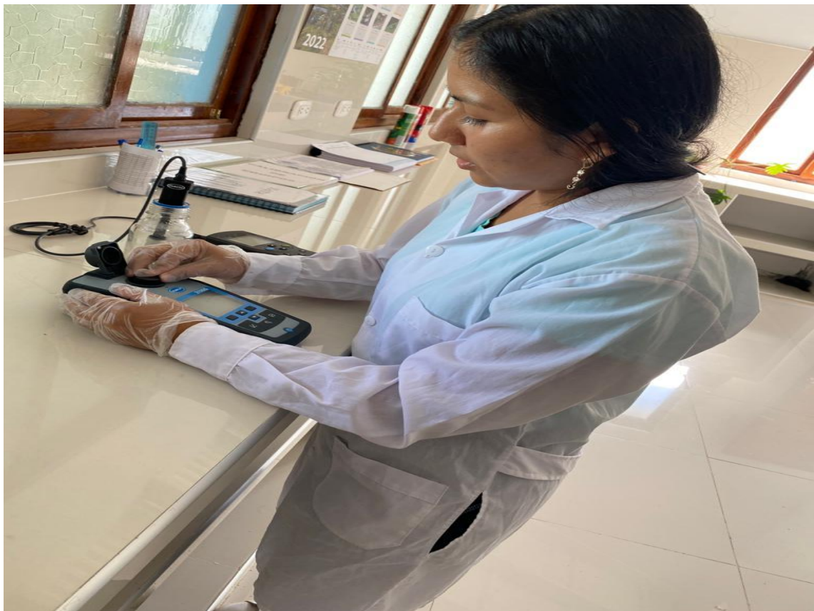
Fotografía N° 06. Evolución de la turbidez de la muestra en el laboratorio de EMAPAB
