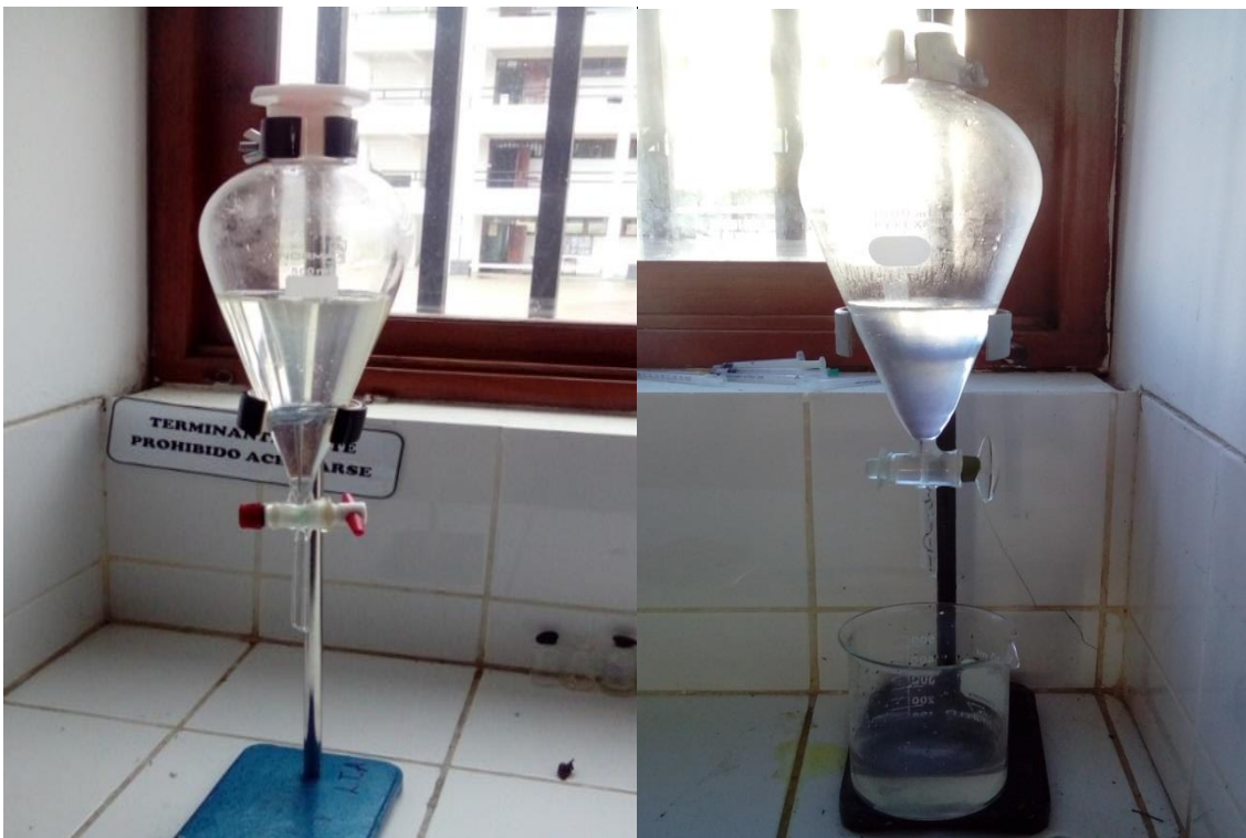
Figura 81. Decantación del aceite esencial
