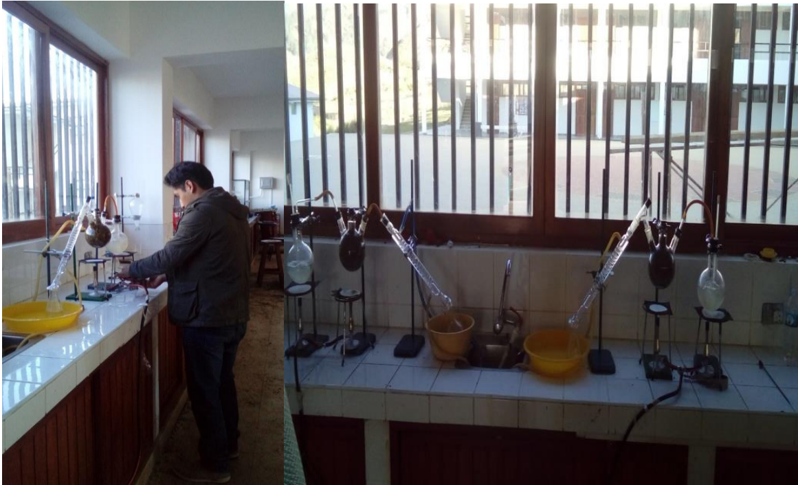
Figura 80. Extracción de aceite esencial – equipo de destilación por arrastre con vapor de agua
