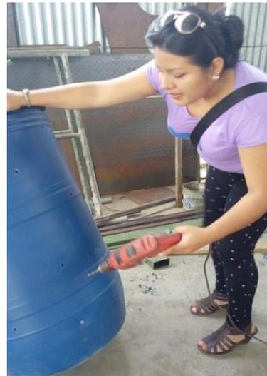
**Diseño, construcción y abertura de orificios de la compostera**
