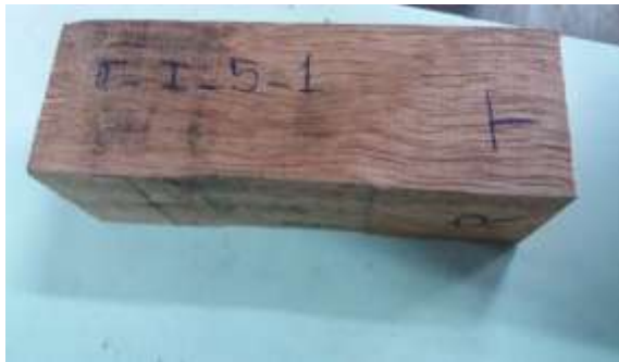
Probetas Después del Ensayo Comp. Perp. Fibra
