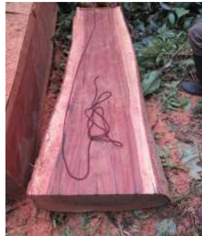
Trazado de las Viguetas ( Inga sp. ).
