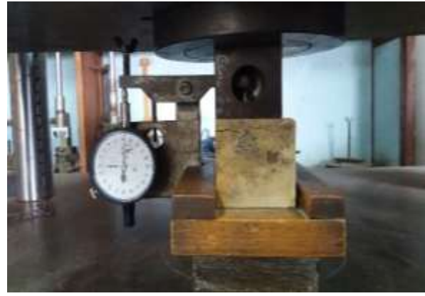
Falla Compresión Perpendicular a la Fibra.
