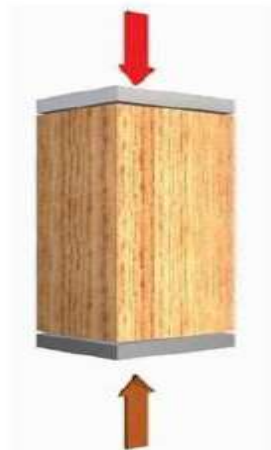
Figura 23: Esquema de ensayo de compresión paralela a las fibras. Fuente: (Fritz et al. , 2004).
