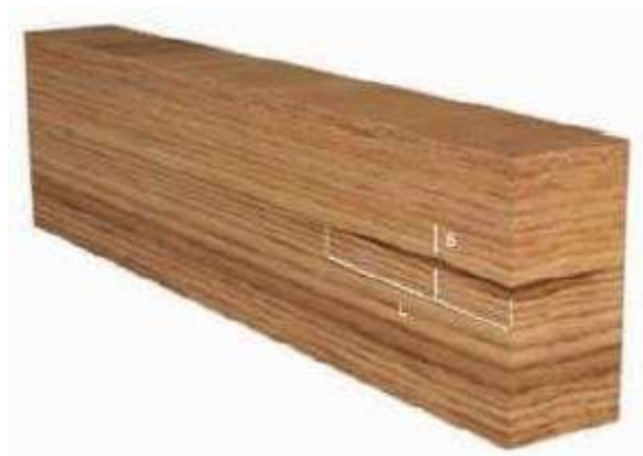
Figura 37: Forma y medición de una acebolladura. Fuente: (Fritz et al. , 2004).
