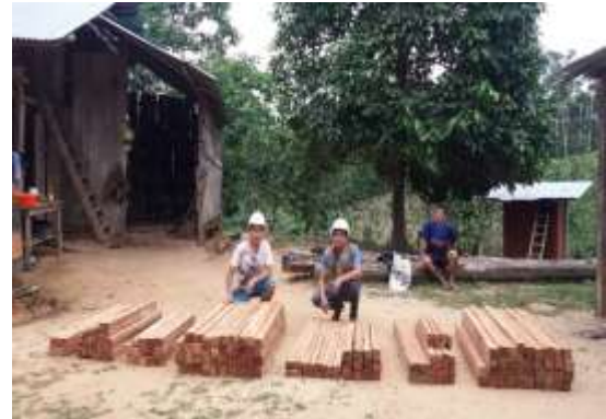
Acondicionamiento de Viguetas para su Transporte ( Inga sp ).
