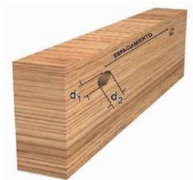
Figura 31: Medición de agujero y/o nudo suelto en el borde de la cara. Fuente: (Fritz et al. , 2004).
