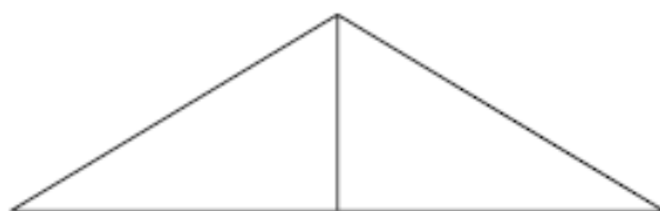
Figura 59: Armadura tipo “A”.
