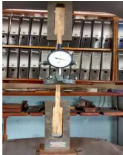
Ensayo Tracción Paralela a la Fibra.
