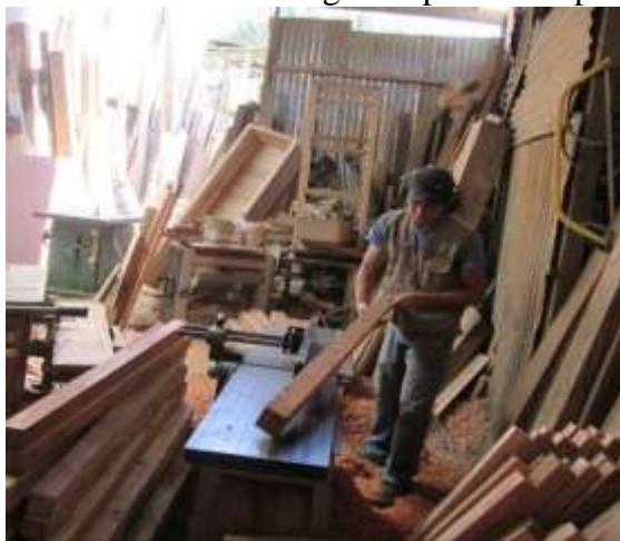
Cepillado de las viguetas en Taller de carpintería.
