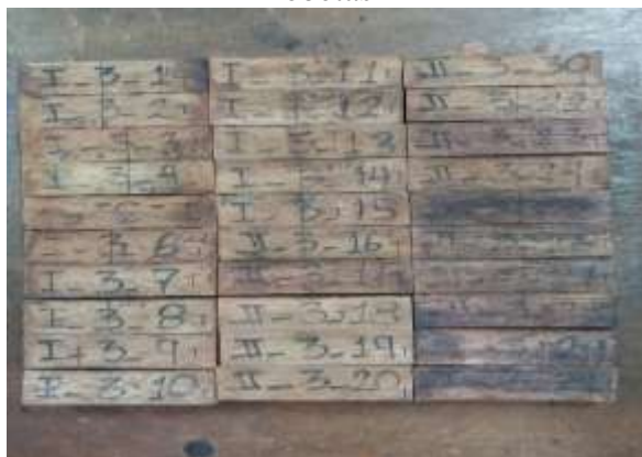
Probetas En estado Anhidro de Ensayo Físicos Previo a su pesado correspondiente.
