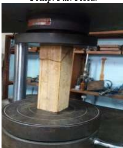
Falla Típica en Compresión Paralela a la Fibra.
