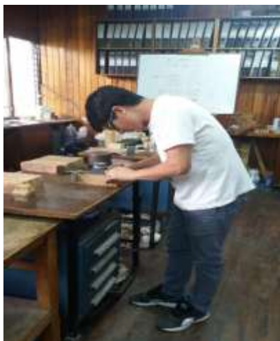
Colocación de Deflectometro a la Prob. Comp. Par. Fibra.
