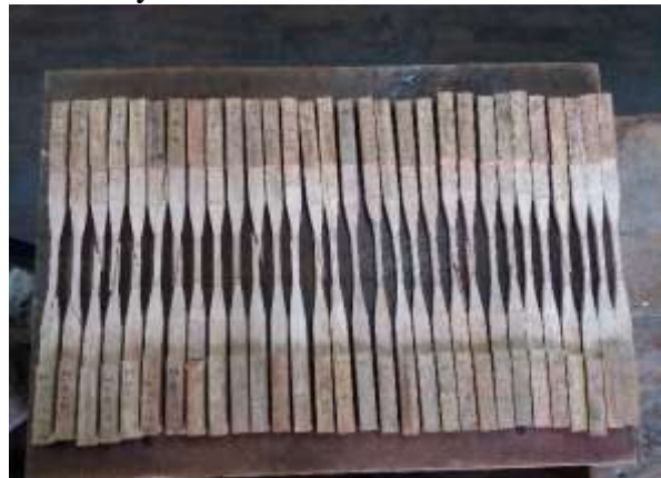
Fallas en Tracción Paralela a la Fibra.
