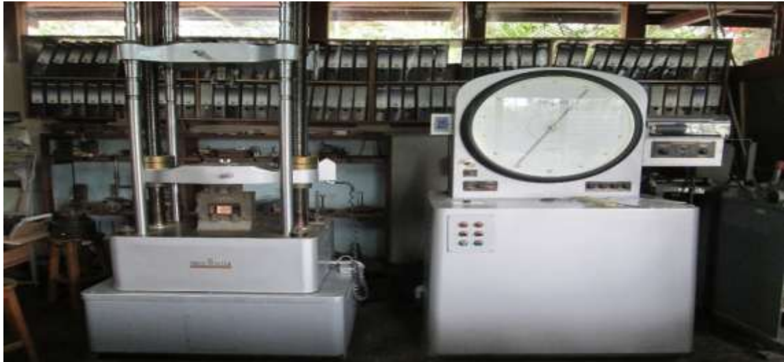
Maquina universal del Laboratorio de Tecnología de la madera de la Facultad de Ciencias Forestales UNALM.
