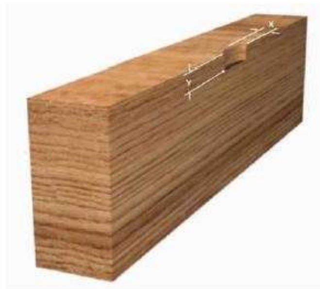
Figura 32: Medición de agujero y/o nudo suelto en la arista. Fuente: (Fritz et al. , 2004).
