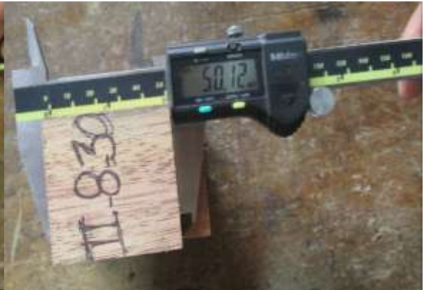
Medidas de Prob. Corte Par. Fibra.
