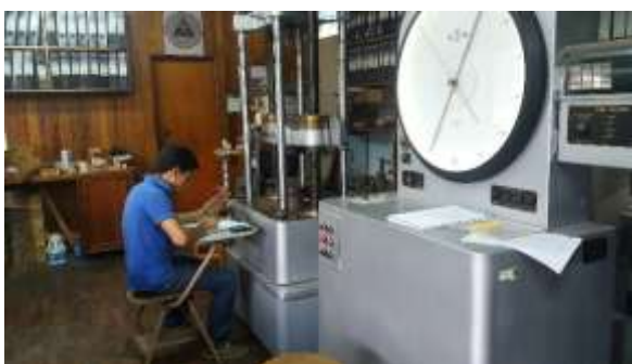
Toma de Datos Falla en Compresión Paralela a la Fibra.
