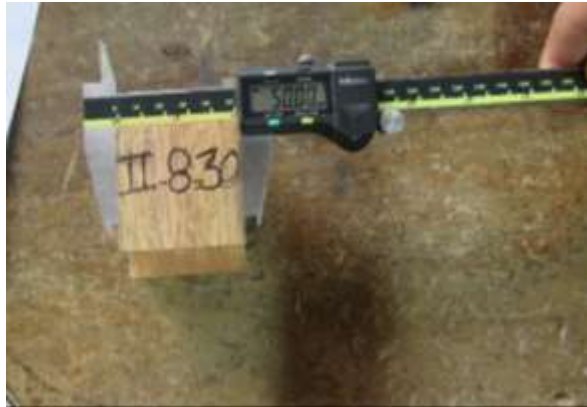
Medidas de Prob. Corte Par. Fibra.
