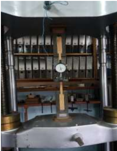
Ensayo Tracción Paralela a la Fibra.
