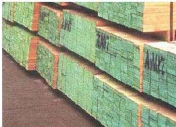
Foto 8: Almacenamiento de la madera en paquetes con uso de separadores.
