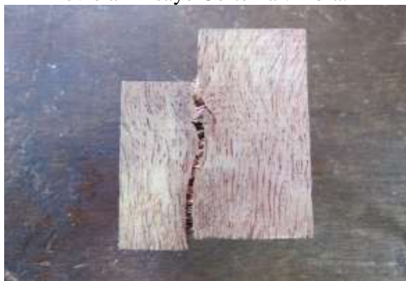
Falla en Ensayo Corte Paralelo a la Fibra.
