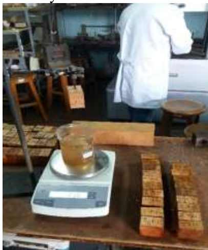
Prob. Flexión Estática Volumen (para C.H. y D.B.)
