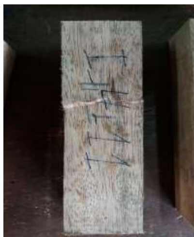
Falla Típica en Cara Tangencial Compresión Paralela a la Fibra.
