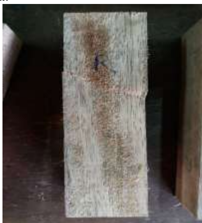
Falla Típica en la Cara Radial en Compresión Paralela a la Fibra.
