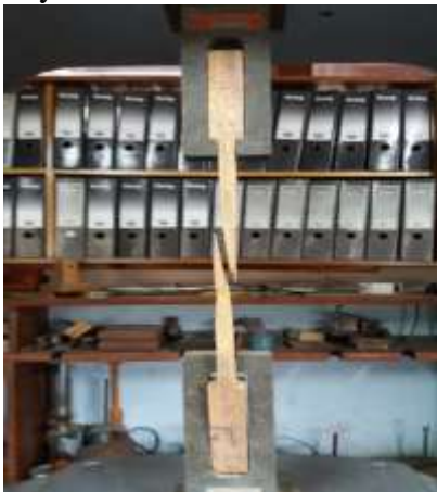
Falla en Tracción Paralela a la Fibra.
