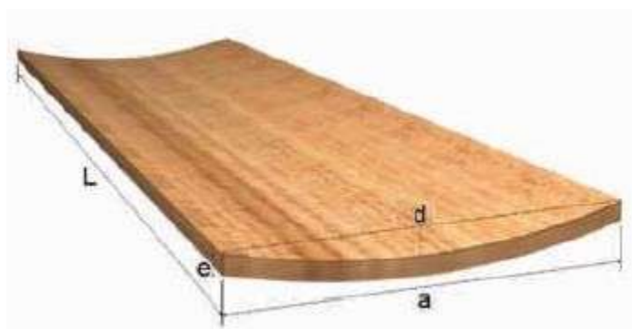
Figura 46: Alabeo o deformación de la madera llamado acanaladura. Fuente: (Fritz et al. , 2004).
