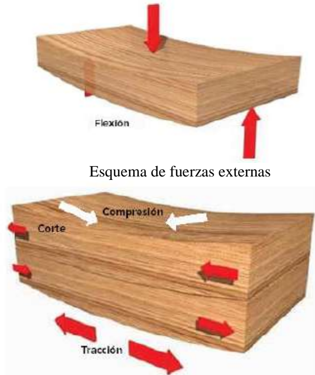
Figura 26: Esquema de ensayo de flexión estática. Fuente: (Fritz et al. , 2004).
