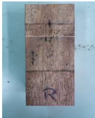
Probetas Después del Ensayo Comp. Perp. Fibra
