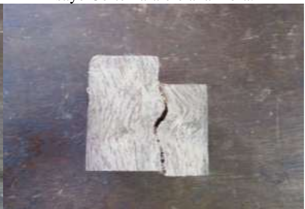
Falla en Ensayo Corte Paralelo a la Fibra
