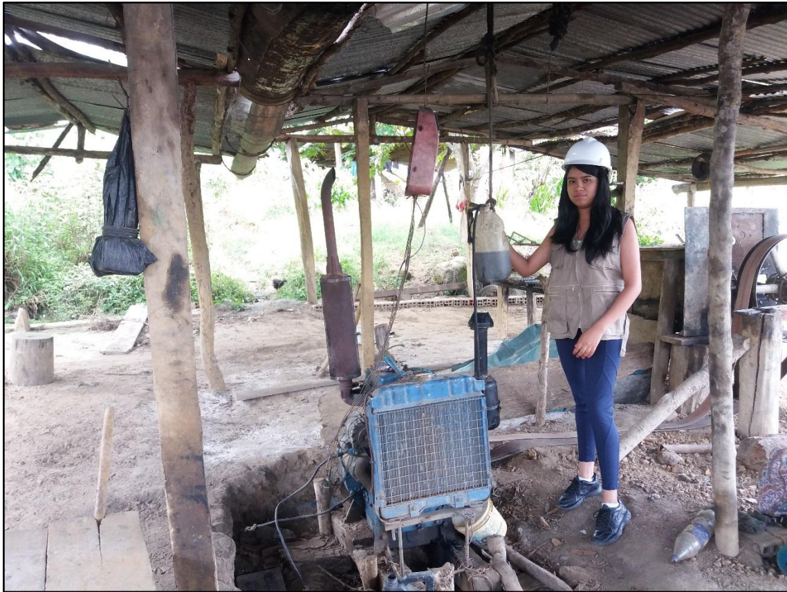
Extrusora mecanizada que funciona con petróleo
