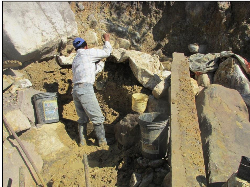
Figura 2. Mina de arcilla de suelo pedregoso con dificultad para su extracción.
