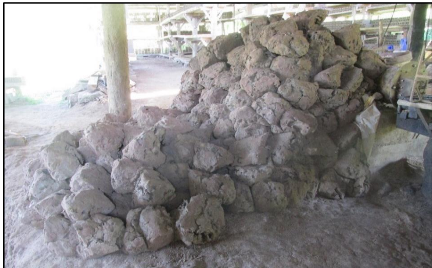
Figura 4. La arcilla y la arena mezcladas en bloques.
