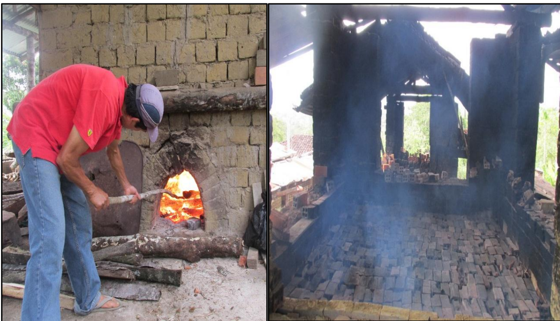
Ladrillos quemados según su capacidad de horno
