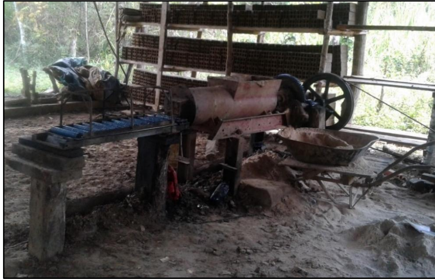
Figura 5. La extrusora para moldear ladrillos.
