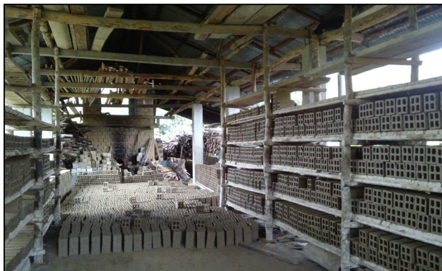
Figura 6. Los ladrillos son secados al ambiente colocados en andamios de madera.
