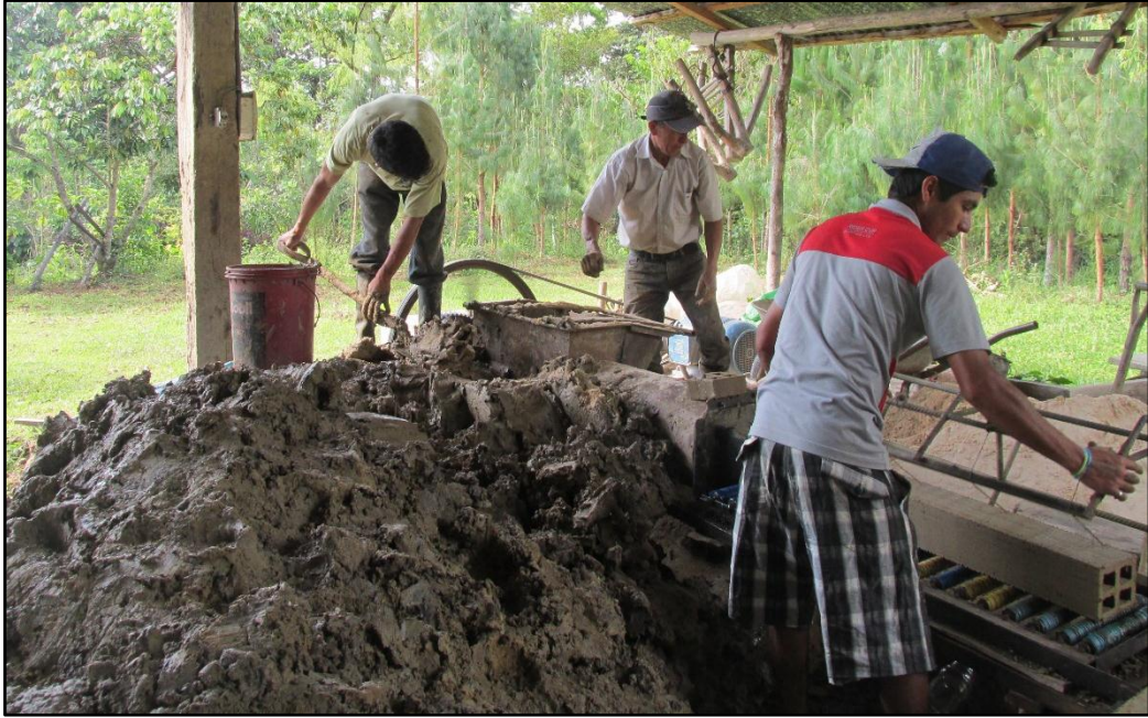
Moldeo de ladrillos con una extrusora mecanizada
