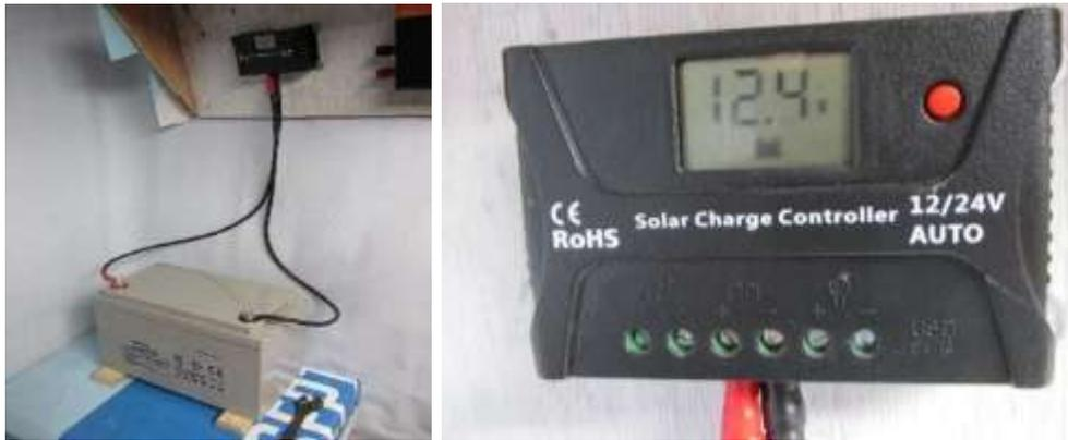
Figura 6. Conexión de la batería al regulador de carga del sistema fotovoltaico, donde se lee que el voltaje de la batería es de 12,4 V
