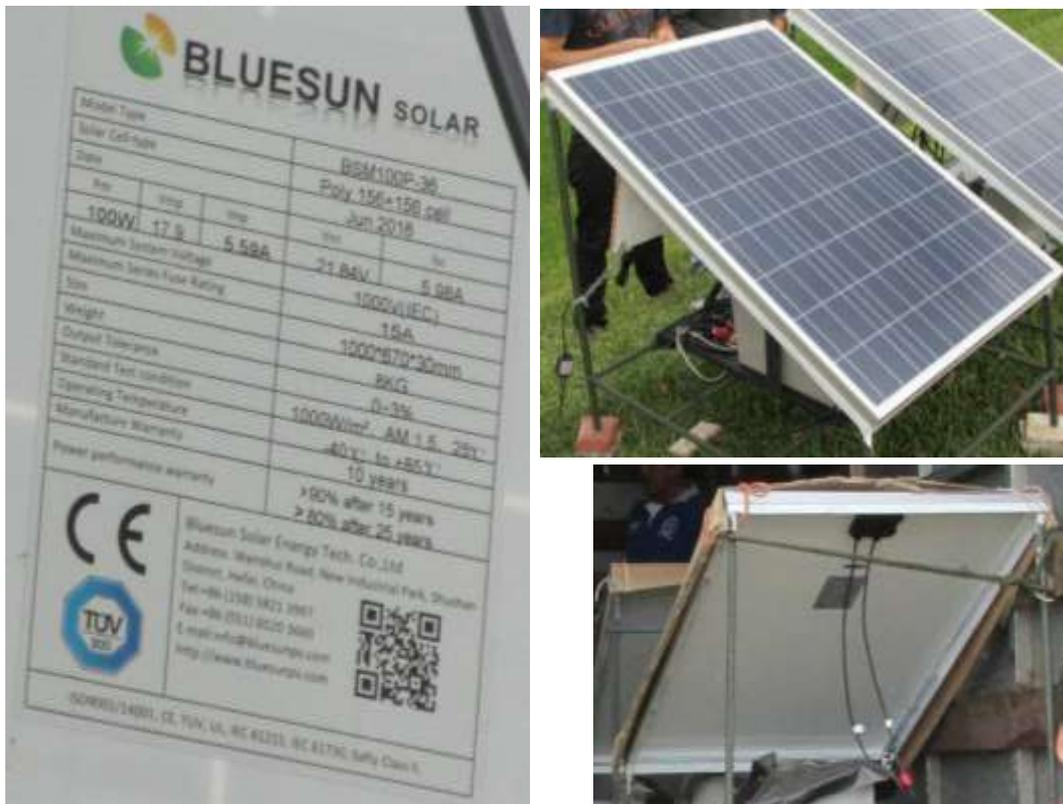
Figura 1. Ficha técnica, superficie de captación y caja de conexión con cables (terminal rojo: positivo; terminal negro: negativo) del panel fotovoltaico de 100 Wp.
