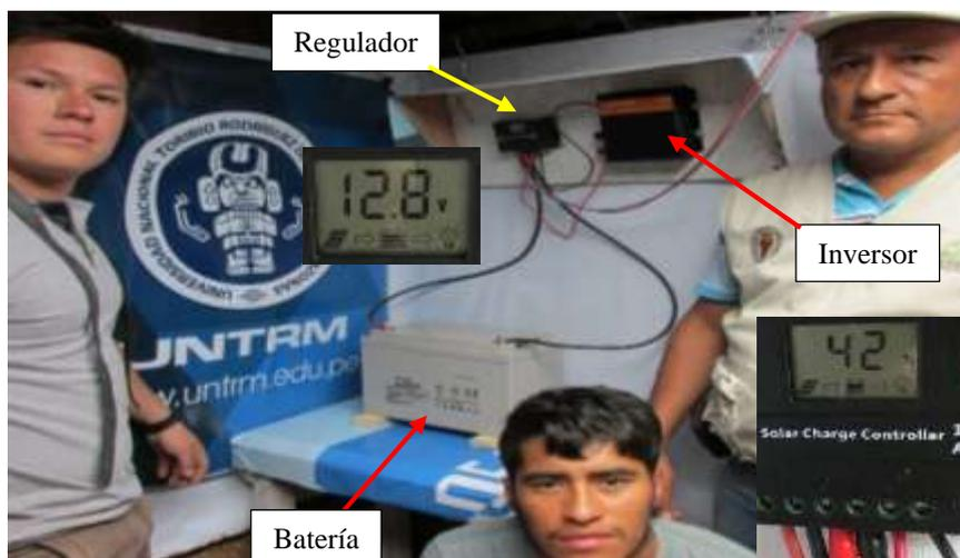
Figura 9. Batería, panel fotovoltaico e inversor conectados al regulador de carga del sistema fotovoltaico, que muestra en su pantalla que el voltaje de la batería está en 12,8 V y la carga de la batería está en 42%
