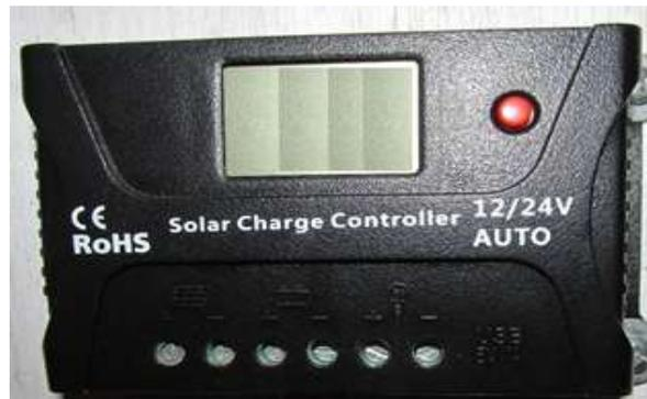
Figura 2. Regulador de carga del sistema fotovoltaico.
