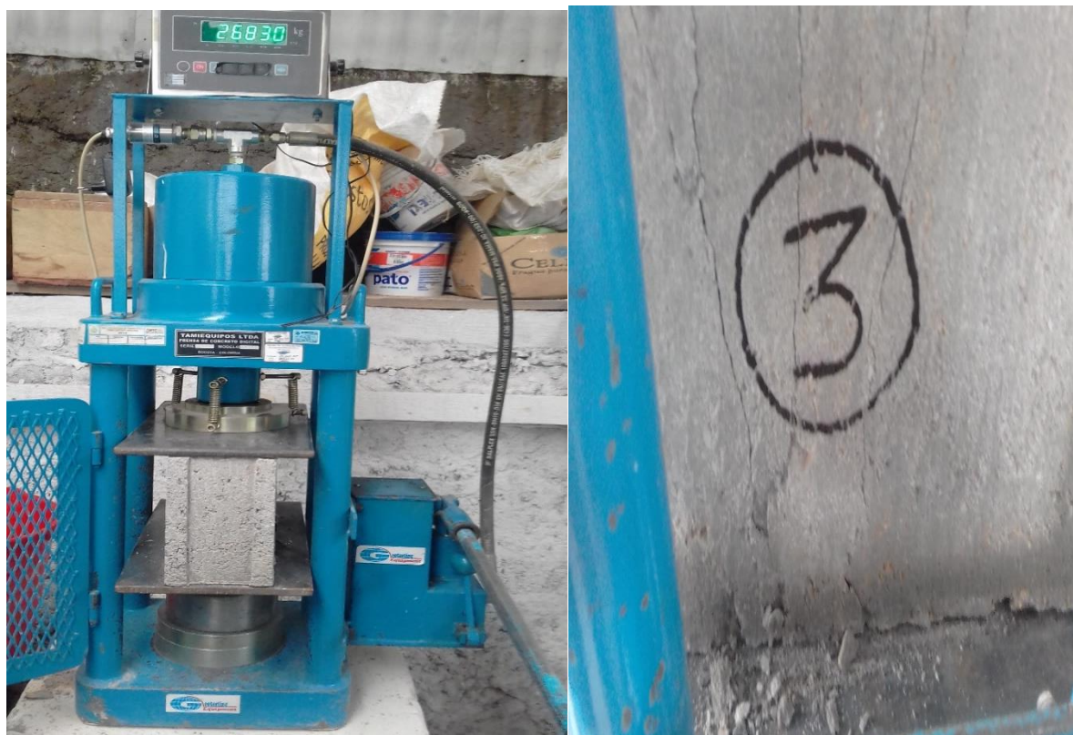
Foto 12: Ensayo resistencia a la compresión.
