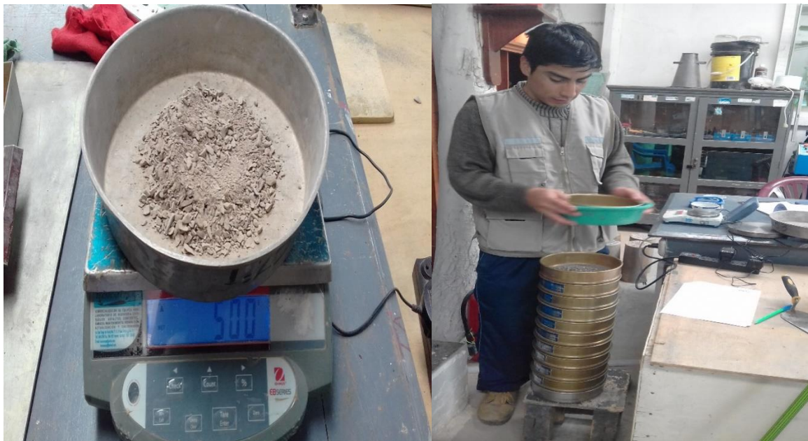
Foto 4: Ensayo granulométrico por tamizado de los agregados y determinación del módulo de fineza.
