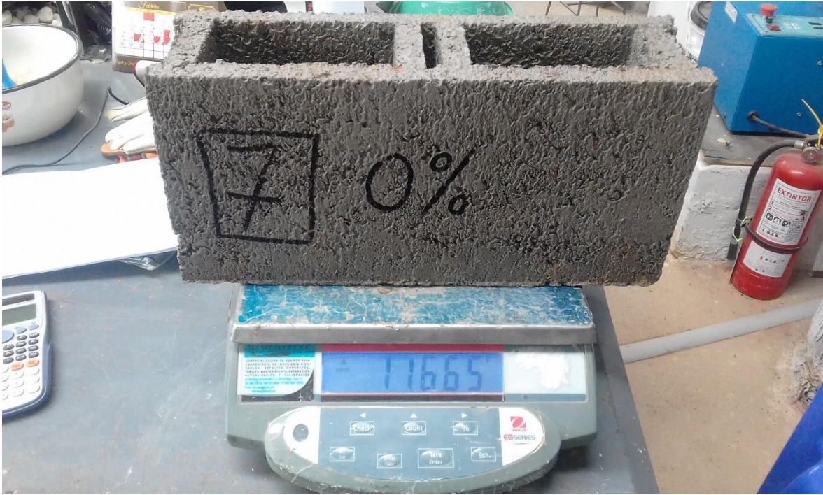
Foto 15: Obtención de la masa seca de los bloques de concreto después de estar 24 horas en el horno.
