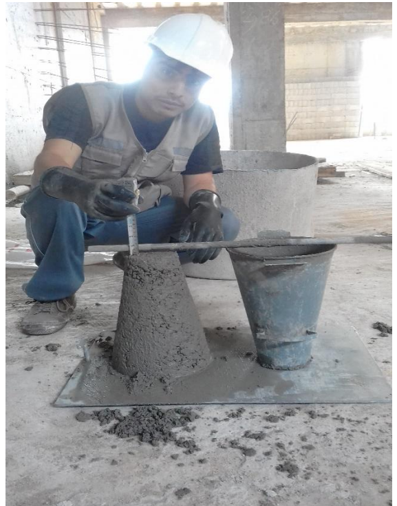
Foto 8: Medición de la consistencia por medio del cono de Abrams.
