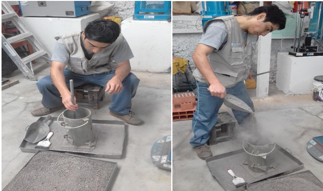
Foto 5: Determinación del peso unitario compactado y peso unitario sin compactar del escombro de losa de pavimento rígido.
