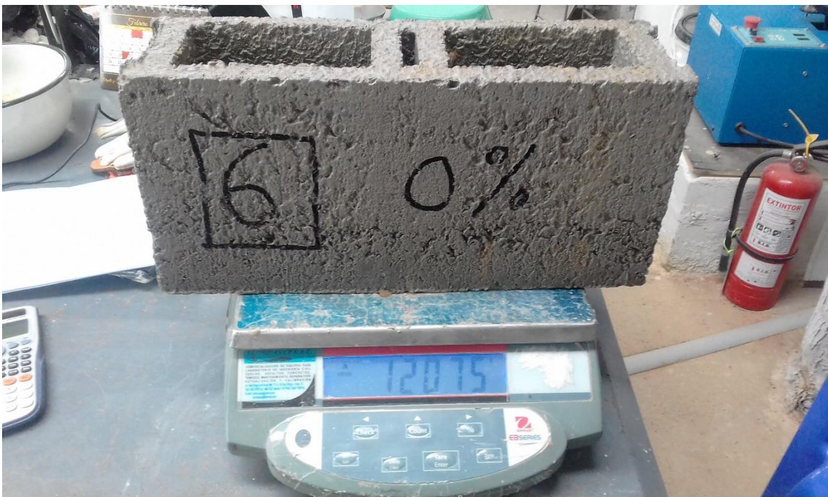
Foto 16: Obtención de masa saturada de los bloques de concreto después de estar 24 horas en el agua.
