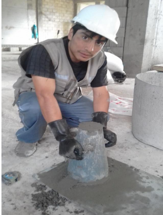
Foto 8: Medición de la consistencia por medio del cono de Abrams.
