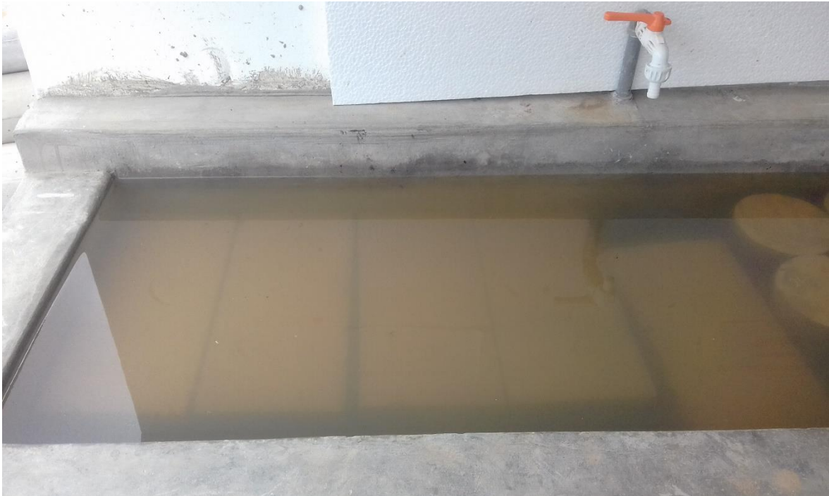
Foto 13: Saturación de los bloques de concreto por 24 horas.
