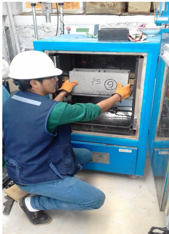
Foto 14: Secado de los bloques de concreto por 24 horas.
