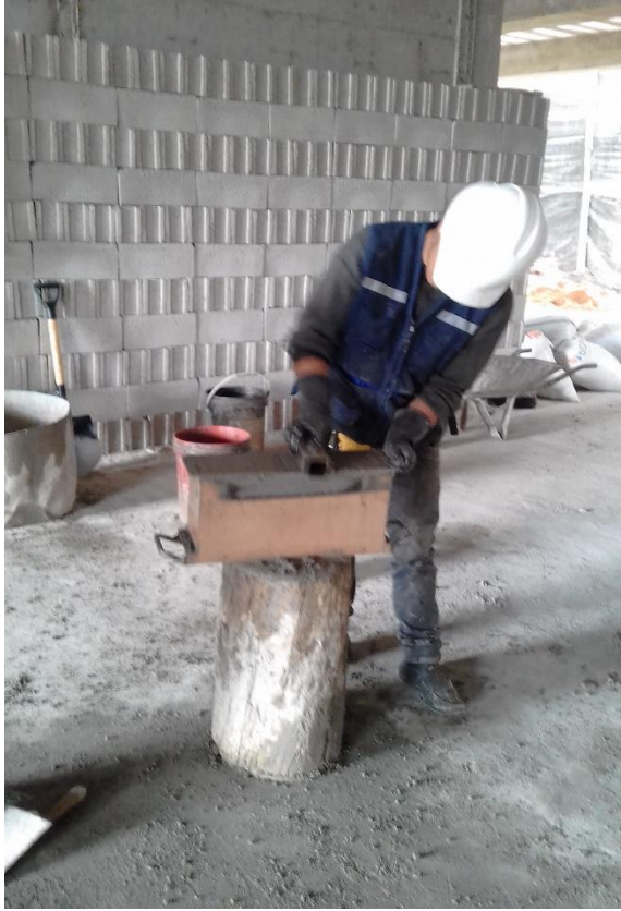
Foto 9: Elaboración de los bloques de concreto y desmolde de los bloques.
