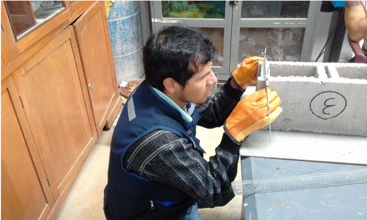
Foto 11: Medición de la variación dimensional de los bloques de concreto.
