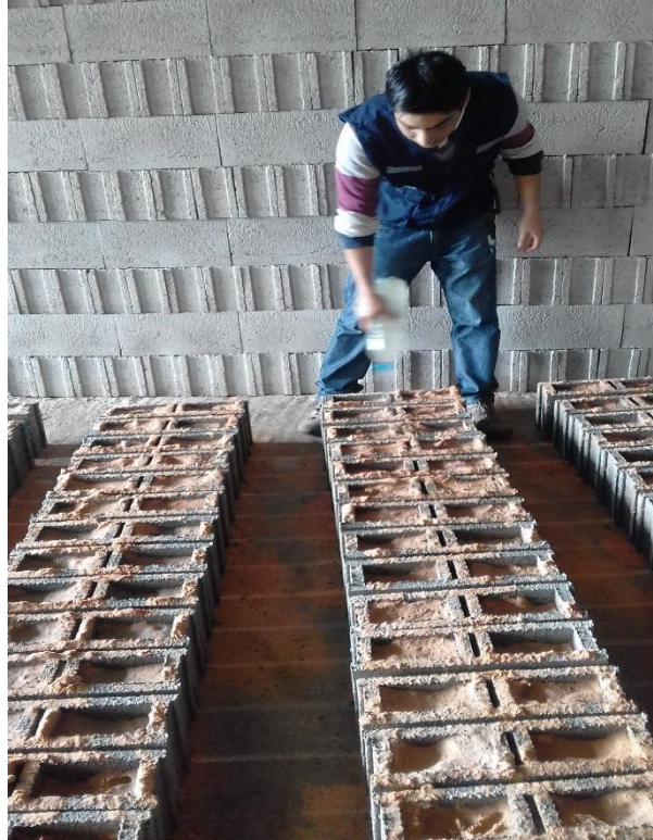
Foto 10: Almacenamiento y curado de los bloques de concreto.
