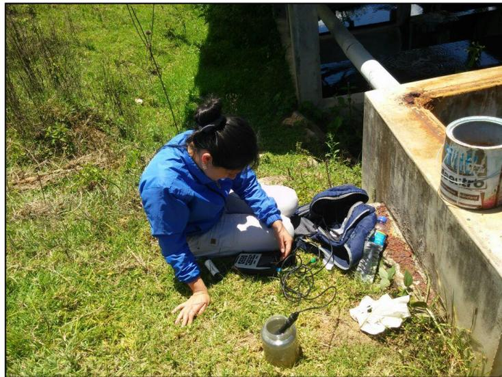
**Figura 15:** Medición del pH del agua residual.
