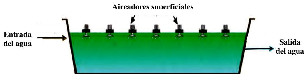
**Figura 1:** Esquema de una laguna de oxidación
