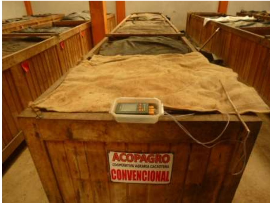
Figura 10. Seguimiento de la temperatura en la fermentación mediante sensores
