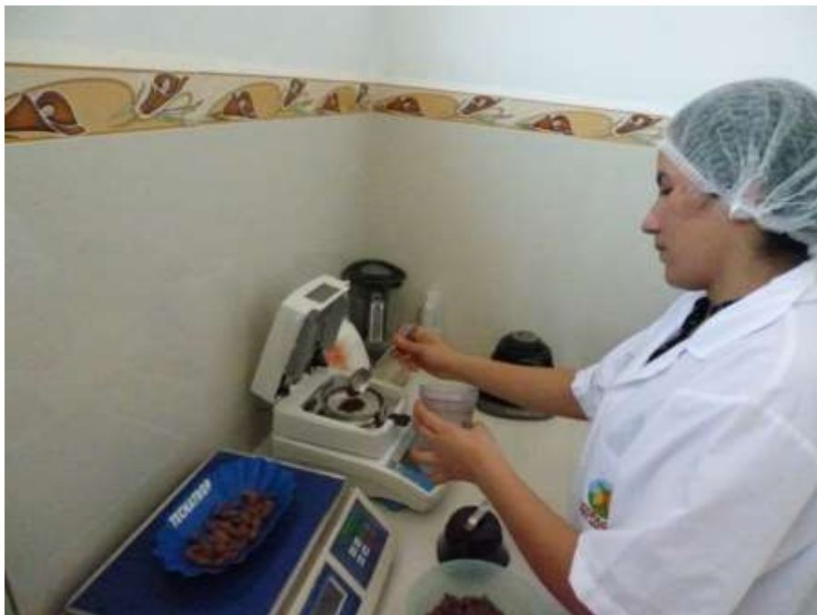
Figura 15. Determinación de humedad
