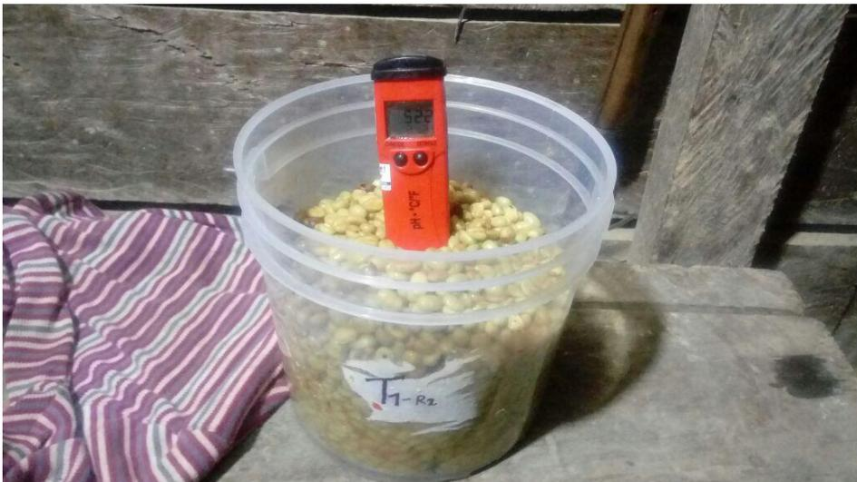
**Fotografía 4. Medición del pH de las muestras, durante y al final de la fermentación**
