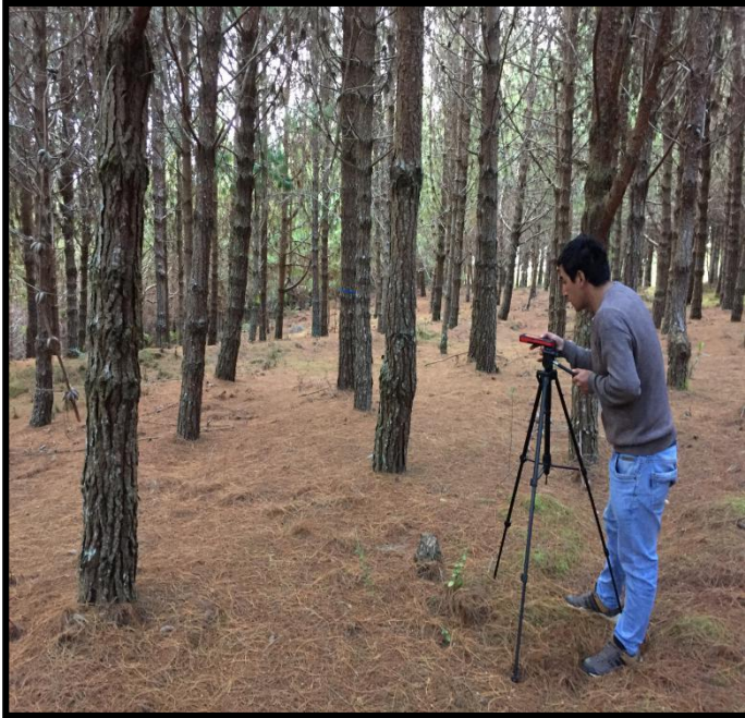
Fotografías 8 y 9. Medición de la altura con el distanciometro laser Leica
