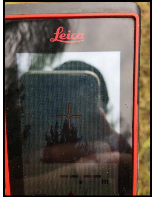
Fotografías 8 y 9. Medición de la altura con el distanciometro laser Leica
