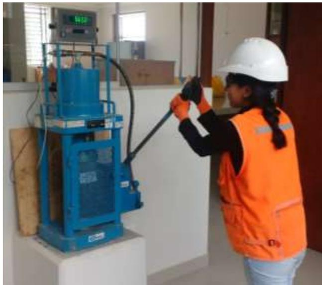
**FOTO 8.** Rotura de la probeta.
