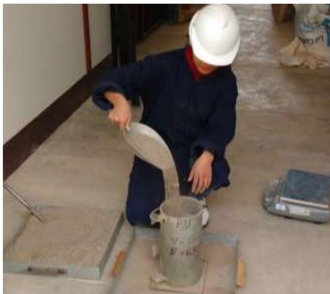
**FOTO 2.** Ensayo de peso unitario compactado del agregado fino.
