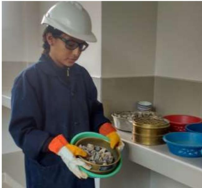
**FOTO 1.** Tamizado del agregado grueso.
