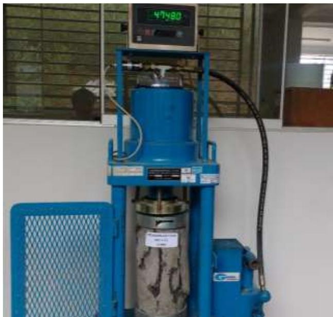
**FOTO 10.** Rotura de la probeta con relación agua/cemento = 0.60 – PET = 7%.
