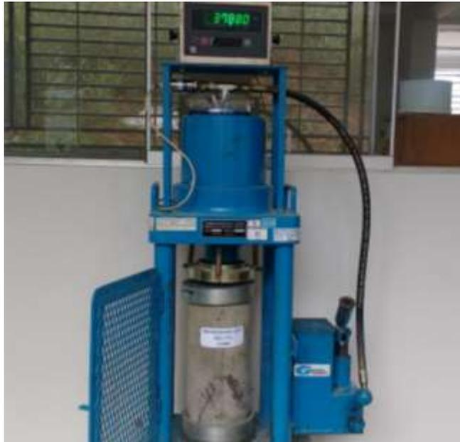
**FOTO 9.** Rotura de la probeta con relación agua/cemento = 0.70 – PET = 7%.
