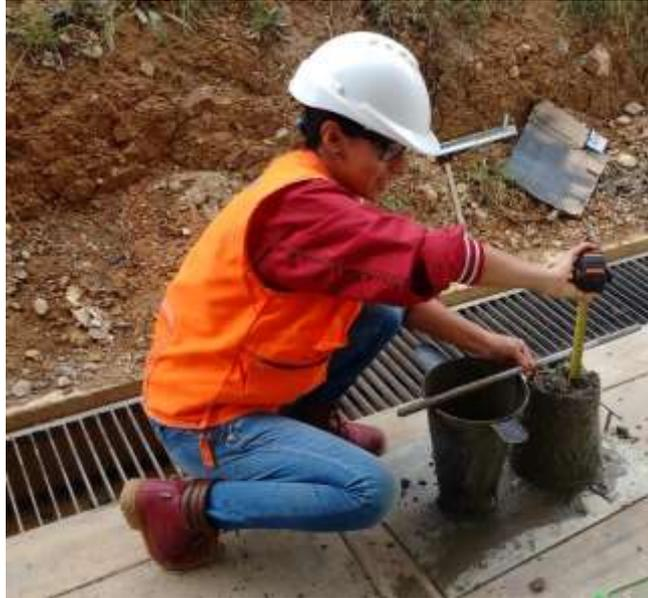
**FOTO 5.** Ensayo del Cono de Abrams.
