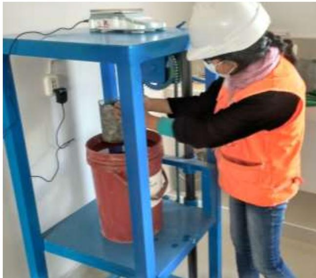
**FOTO 4.** Ensayo de la gravedad específica del agregado grueso.
