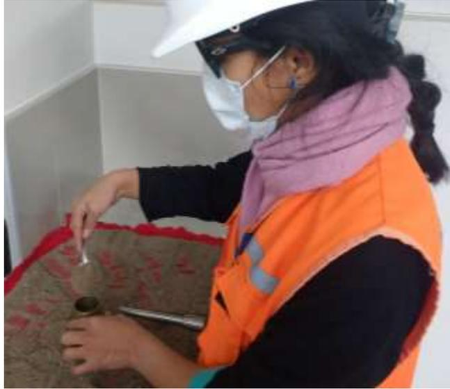
**FOTO 3.** Ensayo de la gravedad específica del agregado fino.
