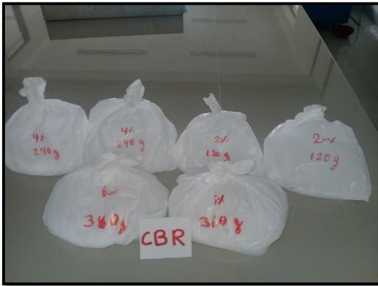
**Foto 26.** En la foto se aprecia el cloruro de magnesio previamente pesado y embolsado para las diferentes concentraciones 2%, 4% y 6% del peso de la muestra, ensayo de CBR.
