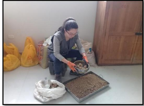
**Foto 16.** Tamizado del material por la malla 3/4", para los ensayos de proctor modificado y CBR.
