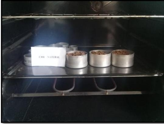
**Foto 37.** Contenidos de humedad de de las muestras preparadas para el ensayo de CBR.
