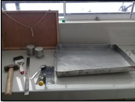
**Foto 19.** En la foto se aprecia los materiales y herramientas para el ensayo de proctor modificado.
