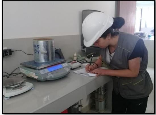
**Foto 36.** Proceso de pesado del molde más la muestra compactada sin saturar, ensayo de CBR.
