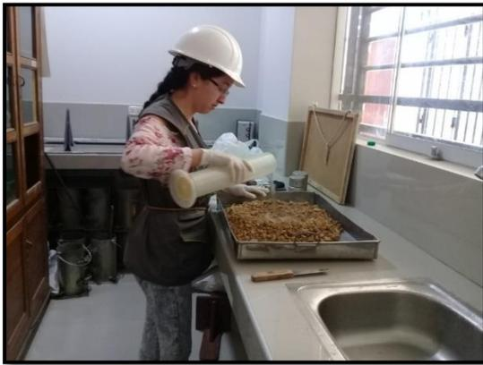
**Foto 20.** Vaciado de agua previamente medido en una probeta graduada, para determinar el óptimo contenido de humedad (muestra con el 0% de  $MgCl_2$ ).
