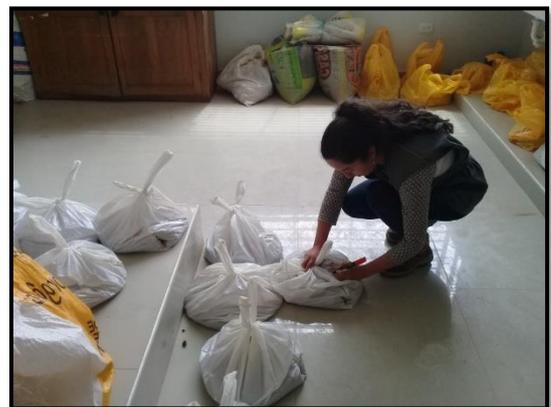
**Foto 18.** Proceso de etiquetado y separación de muestra para proctor modificado y CBR.
