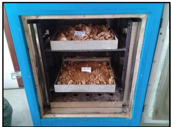
**Foto 05.** Secado del material durante 24 horas a una temperatura de 110 °C.
