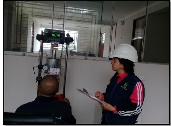
**Foto 39.** Ensayo de penetración aplicando un pisón a una velocidad de 0.05 pul/min.
