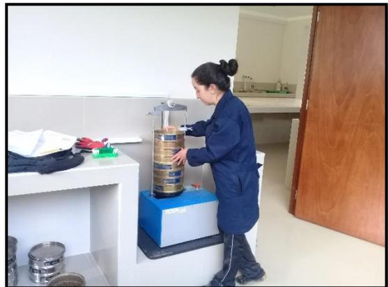
**Foto 11.** Proceso de tamizado del material de cantera (3". 2 1/2", 2", 1 1/2", 1", 3/4", 1/2", 3/8", 1/4" y N°4, 6), tamizadora eléctrica tamiz N° (8,10,16,20,30,40,50,80,100 y 200).
