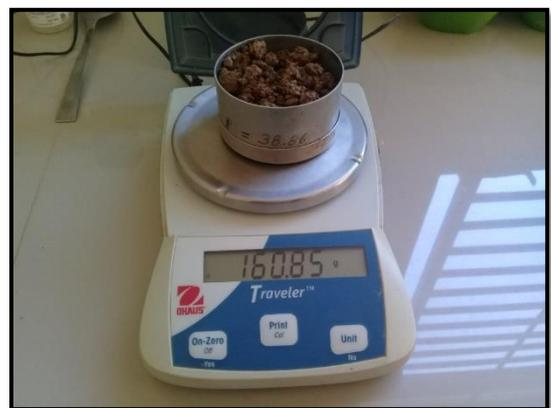
**Foto 30.** Determinación del contenido de humedad para la muestra (para comprobar si coincide con el agua aplicada), ensayo de CBR.
