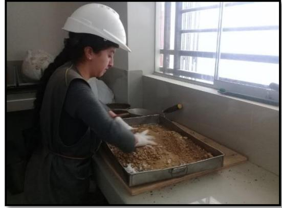
**Foto 28.** Mezclado de la muestra más cloruro de magnesio, ensayo de CBR.
