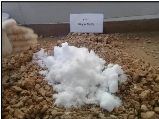
**Foto 33.** Mezclado de la muestra con el 6% de  $MgCl_2$ , ensayo de CBR.
