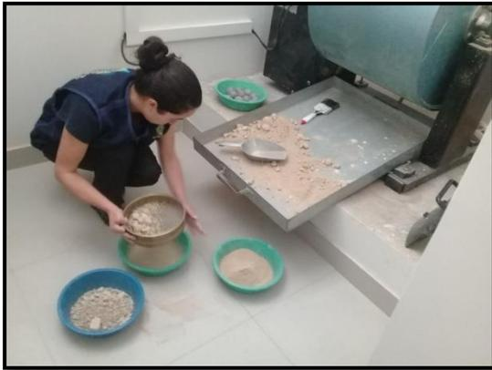
**Foto 14.** Tamizado por la malla N°12 de la muestra sometida a la máquina de los ángeles.
