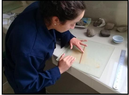
**Foto 10.** Ensayo para determinar el límite plástico de la muestra.
