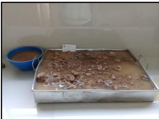
**Foto 09.** Proceso de saturación del material fino y grueso previamente pesado, para el ensayo de análisis granulométrico de suelos por tamizado.
