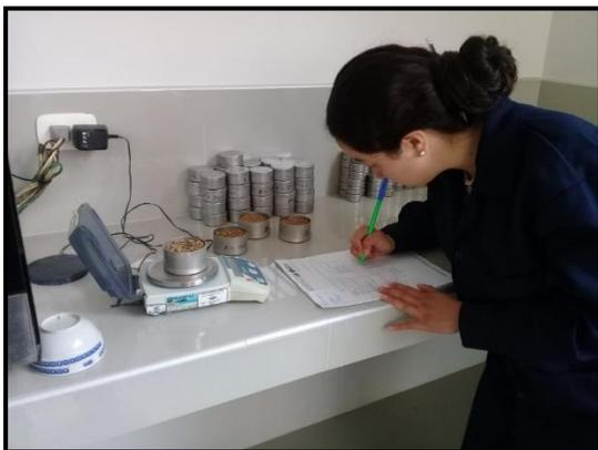
**Foto 03.** Registro del peso del material para el ensayo de humedad natural.
