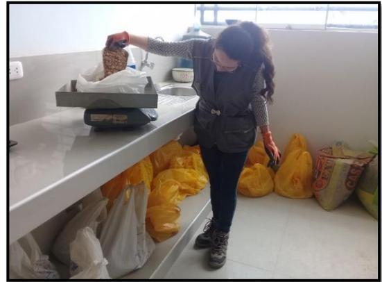
**Foto 17.** Proceso de pesado y embolsado de la muestra para los ensayos de proctor y CBR, 6 kg cada una.
