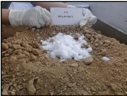
**Foto 32.** Mezclado de la muestra con el 4% de  $MgCl_2$ , ensayo de CBR.
