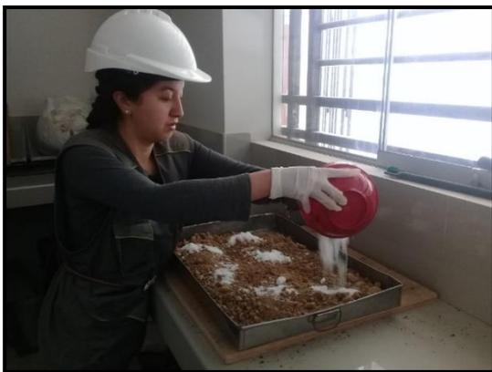
**Foto 27.** Vaciado del cloruro de magnesio en la muestra, ensayo de CBR.
