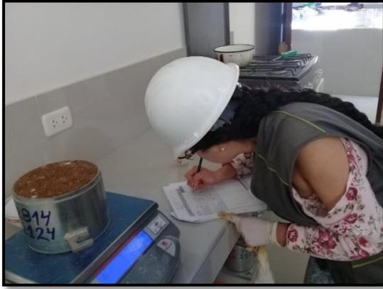
**Foto 25.** Pesado del molde más la muestra compactada, ensayo de proctor modificado con el 0% de  $MgCl_2$ .
