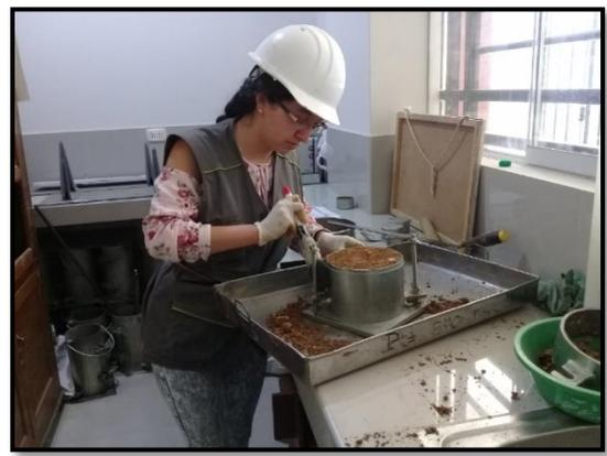
**Foto 24.** Enrazado y limpieza exterior del molde, ensayo de proctor modificado con 0% de  $MgCl_2$ .
