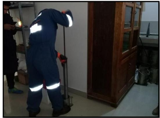
**Foto 23.** Compactación de la muestra por parte del técnico Freddy Gallardo de la Dirección de Transportes y comunicaciones-Amazonas.
