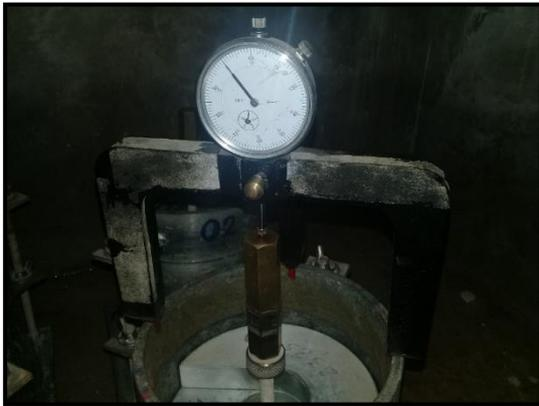
**Foto 38.** Colocación del trípode y dial de expansión sobre el molde de CBR.
