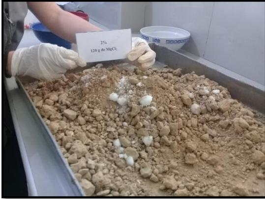
**Foto 31.** Mezclado de la muestra con el 2% de  $MgCl_2$ , ensayo de CBR.
