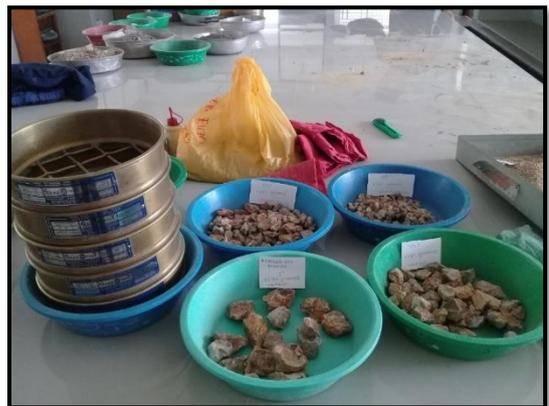
**Foto 12.** Tamizado de la muestra por las mallas 1", 3/4", 1/2" y 3/8", para ser sometidos a la máquina de los ángeles.
