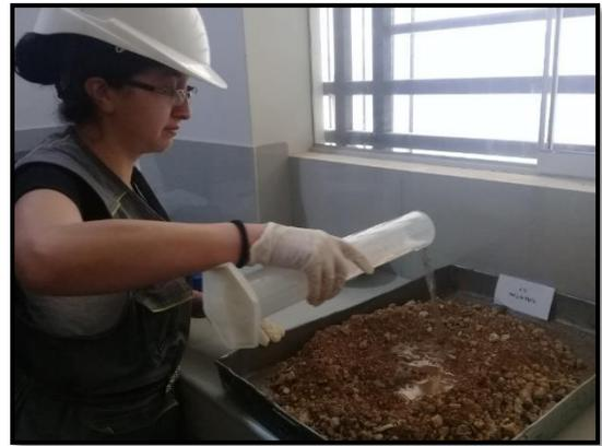
**Foto 29.** Vaciado del agua previamente medido en una probeta graduada, ensayo de CBR.
