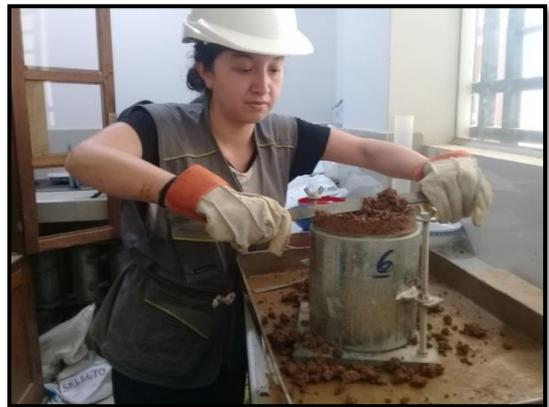
**Foto 35.** Enrazado del material excedente compactado, ensayo de CBR.
