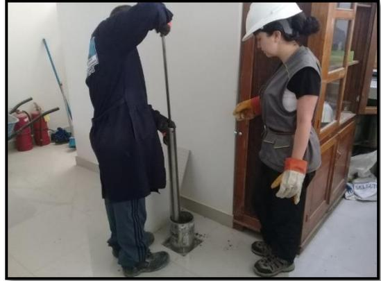
**Foto 34.** Proceso de compactado de la muestra, ensayo de CBR.
