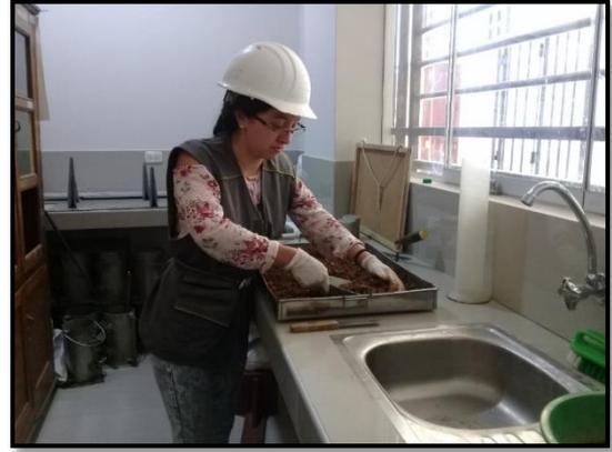
**Foto 22.** División de la muestra en 5 partes para el proceso de compactación (5 capas de 56 golpes cada una).
