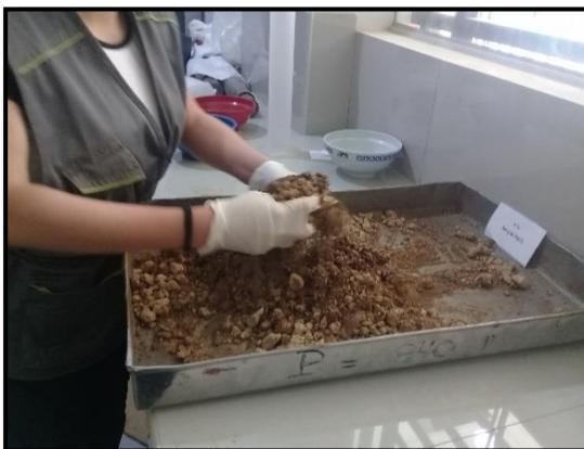
**Foto 21.** Mezclado de la muestra más agua (el proceso me mezclado es hasta que la muestra quede totalmente uniforme).
