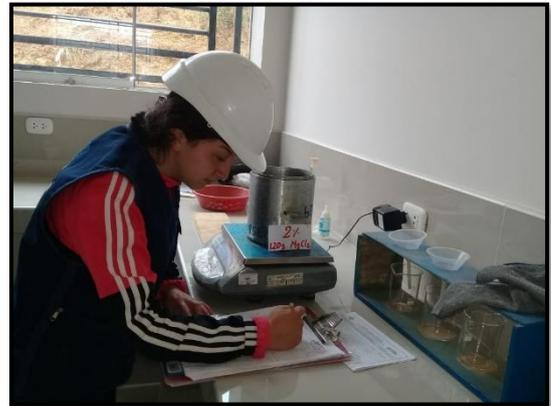
**Foto 40.** Proceso de pesado del molde más la muestra saturada, ensayo CBR.
