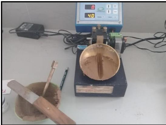
**Foto 08.** Separación de la muestra con el acanalador después de los golpes en la cazuela de casa grande.
