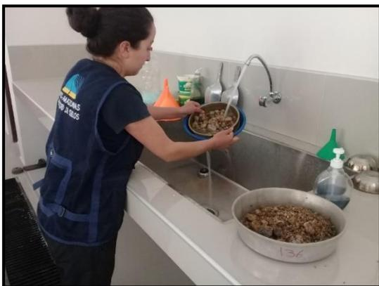
**Foto 15.** Lavado del material retenido por la malla N°12, para luego ser secado a una temperatura de 110 °C, durante 24 horas.
