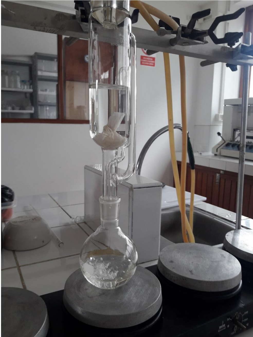
Figura 18. Extracción de lípidos en el equipo Soxhlet para determinar el porcentaje de lípidos en cada tratamiento.
