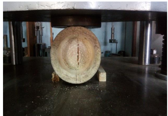
Falla Compresión Perpendicular a la Fibra Con Nudo.
