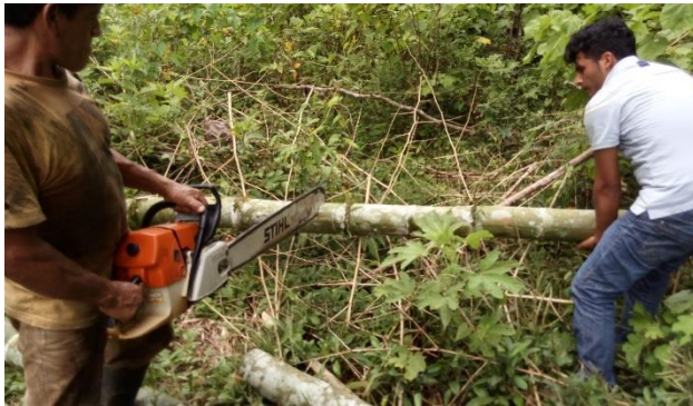
Corte de la Troza de L=2.00\text{m} Bambú.
