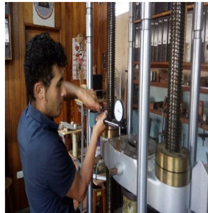
Colocación de Deflectometro a la Prob. Comp. Par. Fibra.
