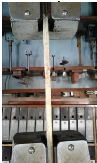
Falla en Tracción Paralela.
