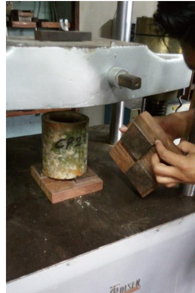
Ubicando la Probeta en la Maquina Universal con Accesorio para el ensayo de Corte.
