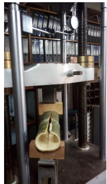
Falla Típica en probetas Flexión Estática.
