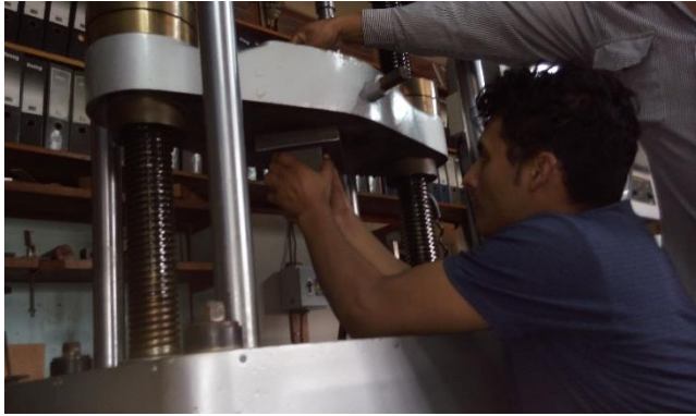
Equipando con accesorios para ensayo de flexión la Máquina Universal.
