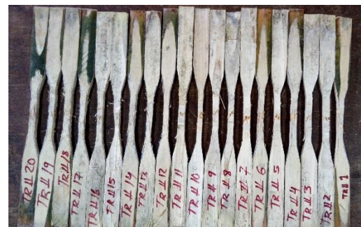
Ensayo Tracción Paralela.
