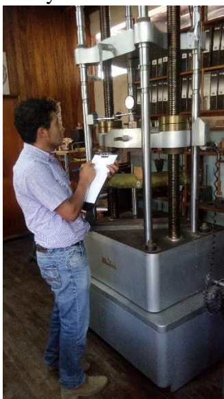
Control de Deformación en Flexión Estática.
