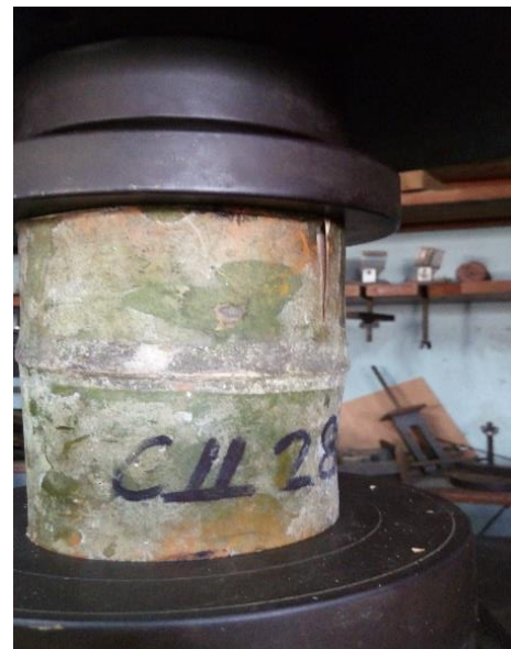
Falla Típica en la Cara Radial en Compresión Paralela a la Fibra.
