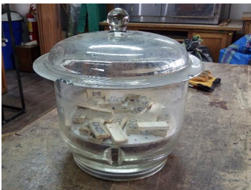
Proceso de Enfriamiento en Desecador De Probetas.
