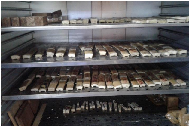
Proceso de Secado al Horno Para obtener Probetas en estado Anhidro.
