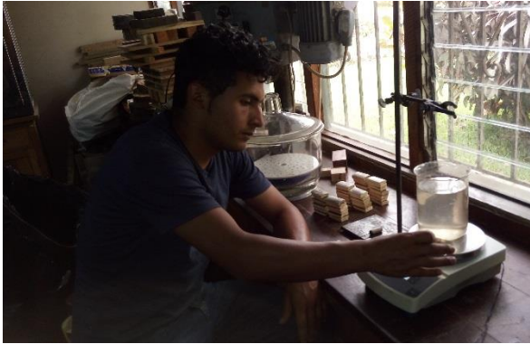
Peso de Probetas Para Determinar el Volumen Para Ensayos Físicos
