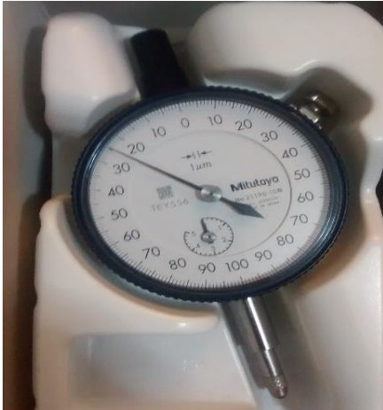
Reloj Deflectometro ( \mu\text{m} ).
