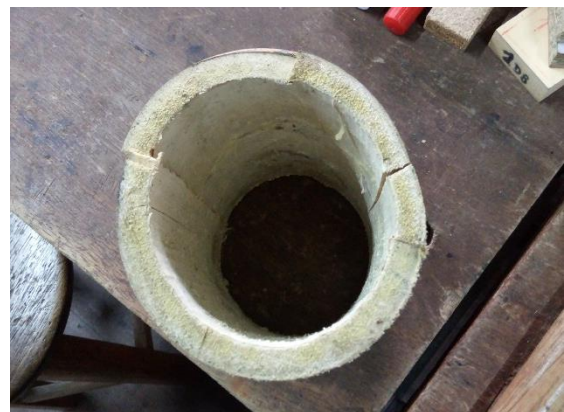
Falla en Ensayo Corte Paralelo a la Fibra.
