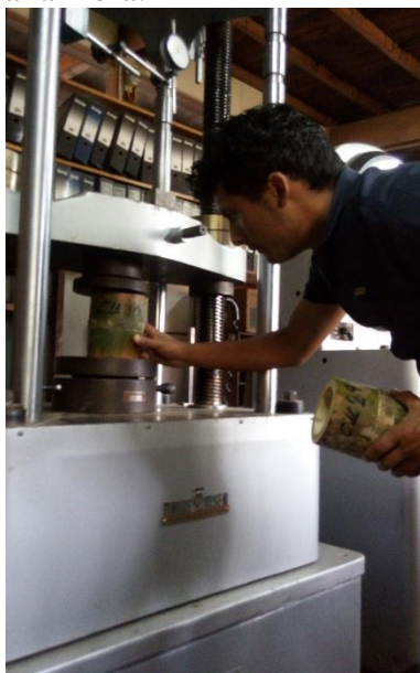
Realizando el cambio de probeta luego de ser ensayada en Compresión Paralela a la Fibra.
