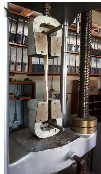
Ensayo Tracción Paralela.
