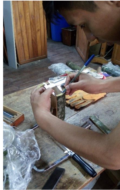
Extracción de Muestras Para Ensayos Mecánicos de la Parte Cercana a la Falla.
