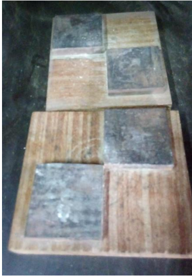
Accesorios Para Ensayos de Corte Paralelo.
