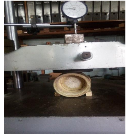
Falla Compresión Perpendicular a la Fibra Con Nudo.
