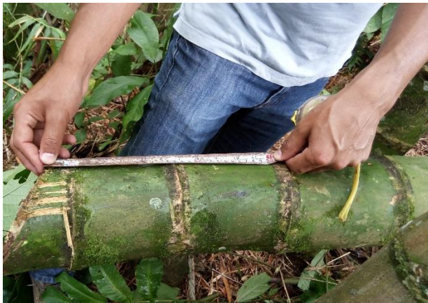
Parte basal de la caña de bambú para ser descartada l=30 - 40\text{ cm} .
