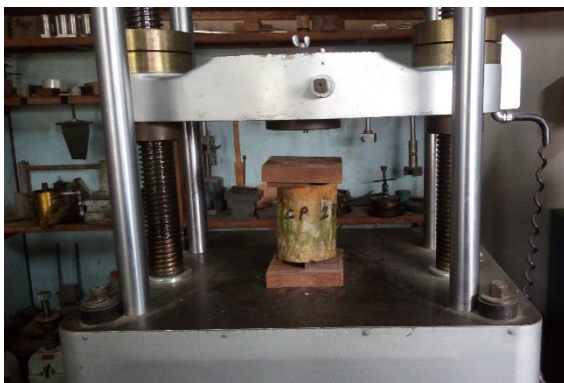
Ensayo Corte Paralelo a la Fibra.
