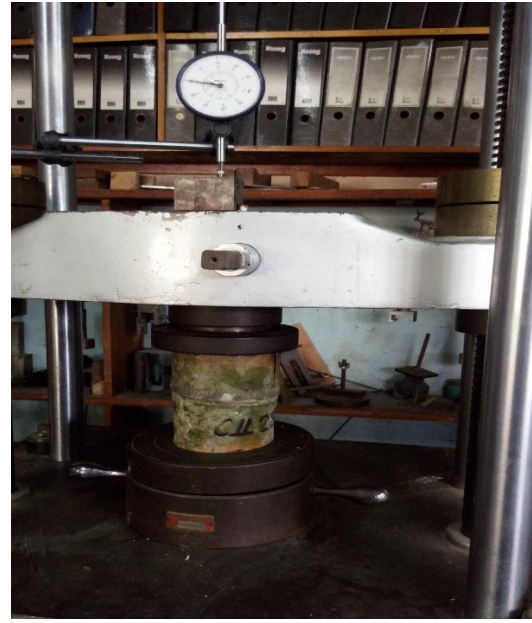
Ensayo Compresión Paralela a la Fibra Con Nudo.
