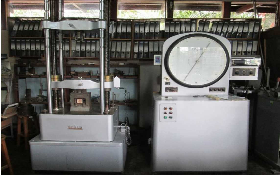
Maquina universal del Laboratorio de Tecnología de la madera de la Facultad de Ciencias Forestales UNALM.
