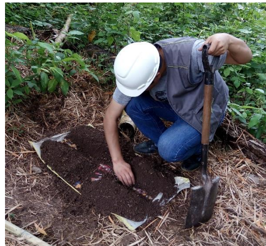
Selección de la muestra de suelo mediante el método de cuarteo.
