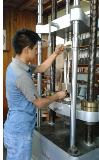
Acomodo de Probeta en Maquina Universal.
