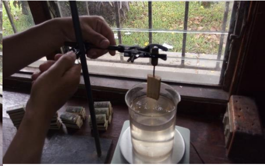
Determinación de Volumen en estado verde Para Probetas de Ensayos Físicos.
