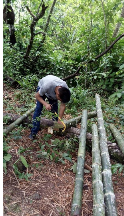
Acondicionamiento manual de trozas de bambú.
