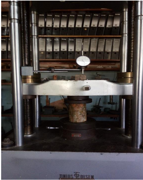
Ensayo Compresión Paralela a la Fibra Sin Nudo.
