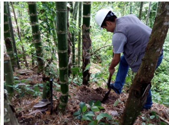
Excavación de terreno para extraer muestras para el laboratorio de suelos.
