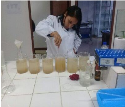
Figura 42. Colocación de la pasta coagulante a las muestras de agua y agitación por un minuto.
