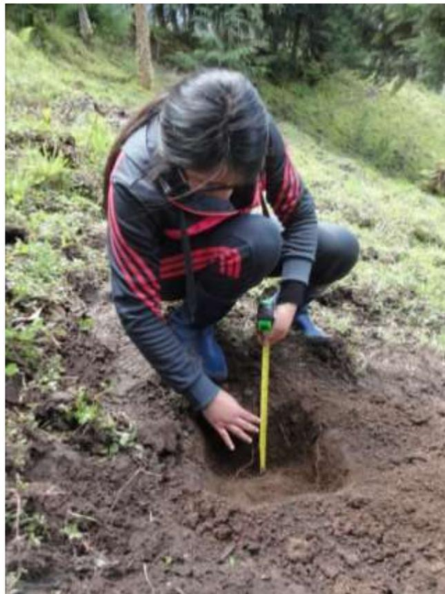
*Figura 4.* Medición de profundidades para obtener las muestras de suelo.
