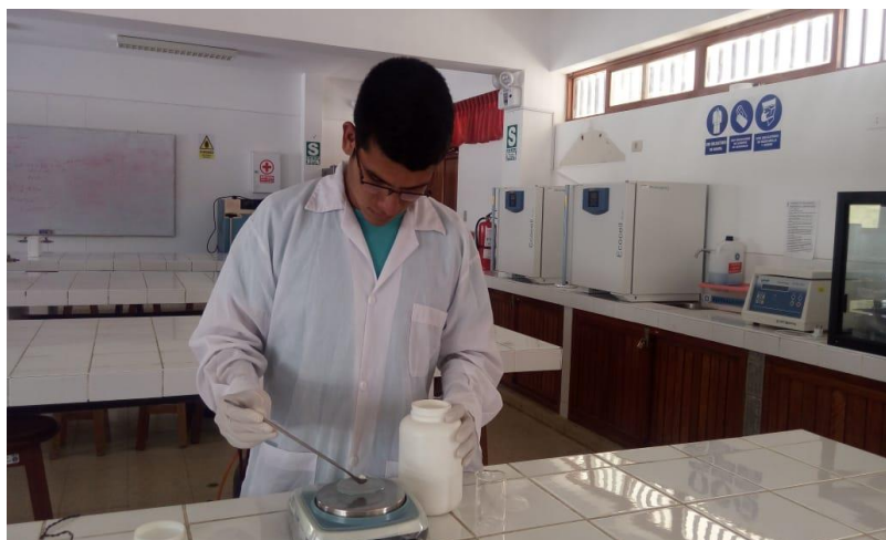
Figura N° 04. Pesado de 20, 25, 30, 35 y 40 ppm \text{Al}_2(\text{SO}_4)_3 .
