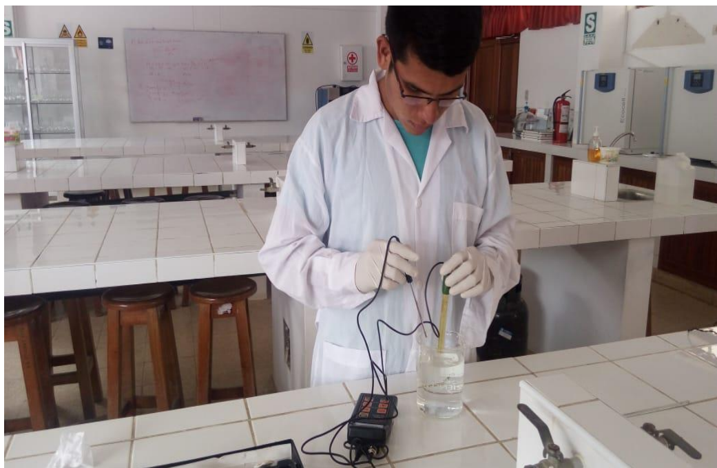
Fotografía N° 02. Comprobación de Ph
