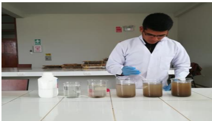
Figura N° 05. Ensayo de jarras de 5 muestras, a 25°C temperatura ambiente, utilizando \text{Al}_2(\text{SO}_4)_3
