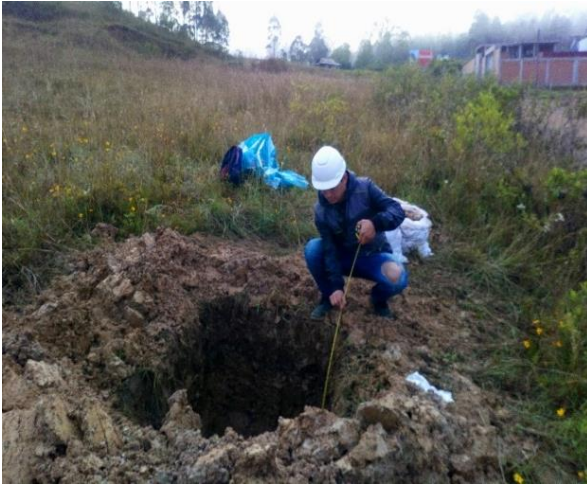
Figura 12. Obtención de la muestra de suelo arcillosos mediante una calicata
