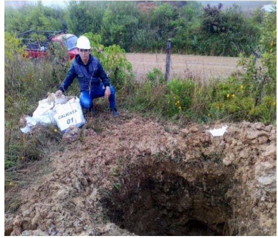
Figura 12. Obtención de la muestra de suelo arcillosos mediante una calicata
