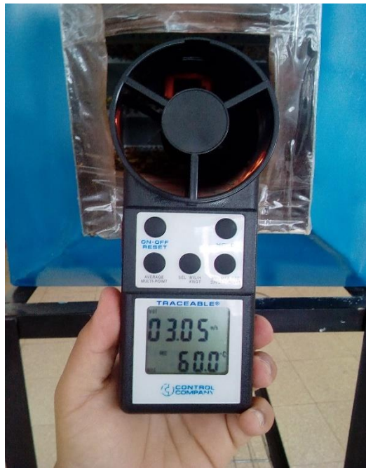
Foto 4. Medición de la temperatura y velocidad de aire con el anemómetro
