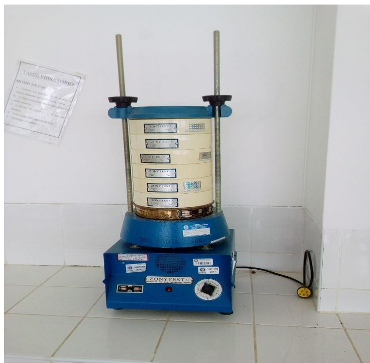
Foto 8. Después de la molienda se utilizó la zarandadora eléctrica para obtener muestra con malla 50 y 100.
