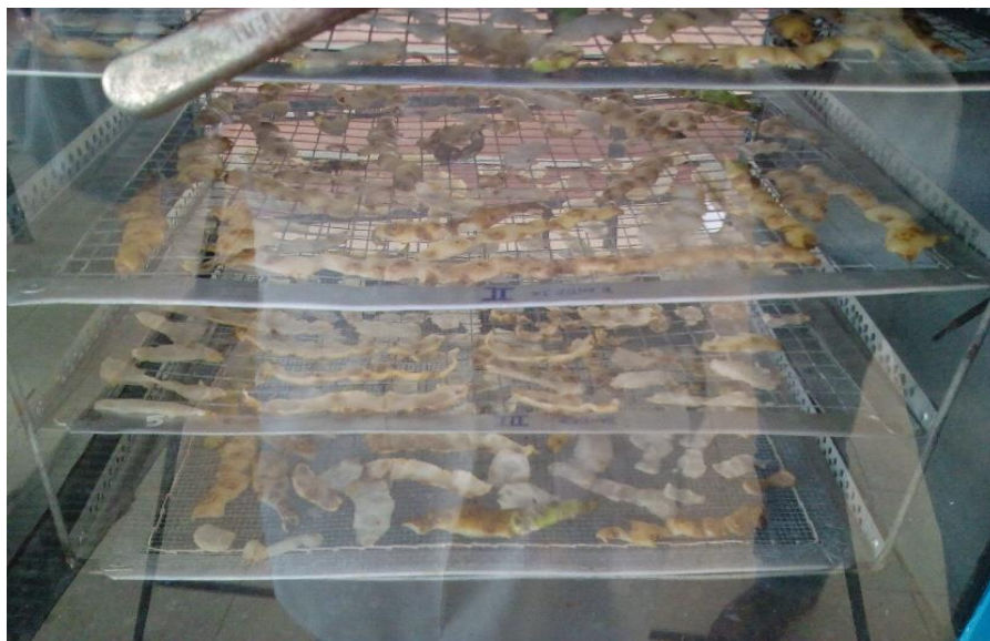
Foto 2. Distribución de rodajas de noni en las bandejas del secador de bandeja
