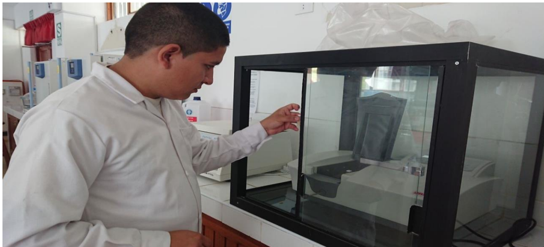
Foto 18. Colocando las muestras en espectrofotómetro para determinar la absorbancia
