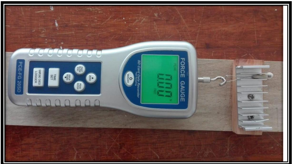
**Foto 07:** Medición en newtons en el proceso experimental.
