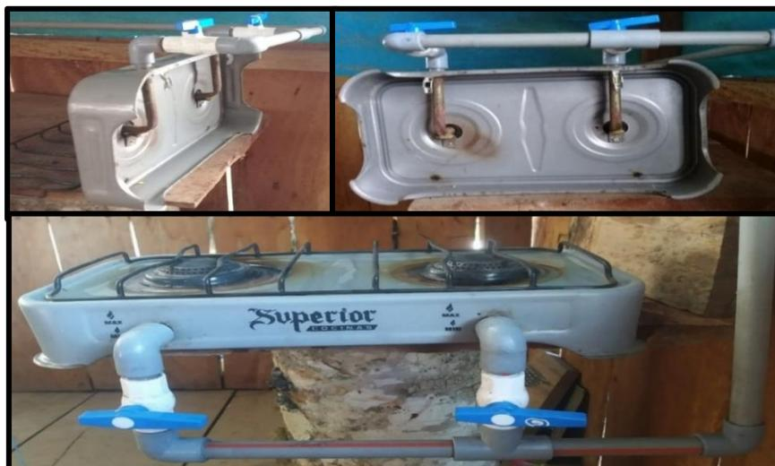
**Figura 17.** Cocina de dos hornillas adaptada a biogás.
