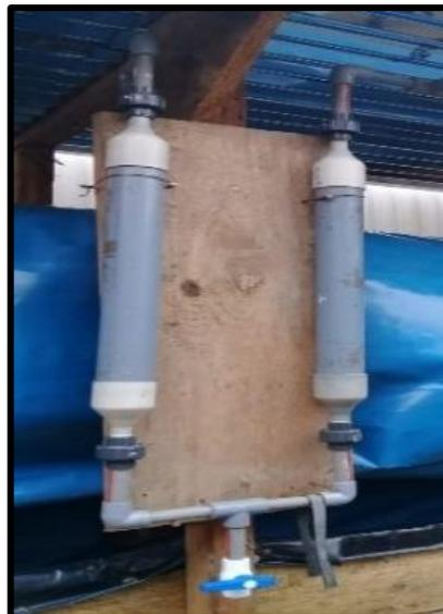
**Figura 10.** Sistema para la purificación del biogás.
