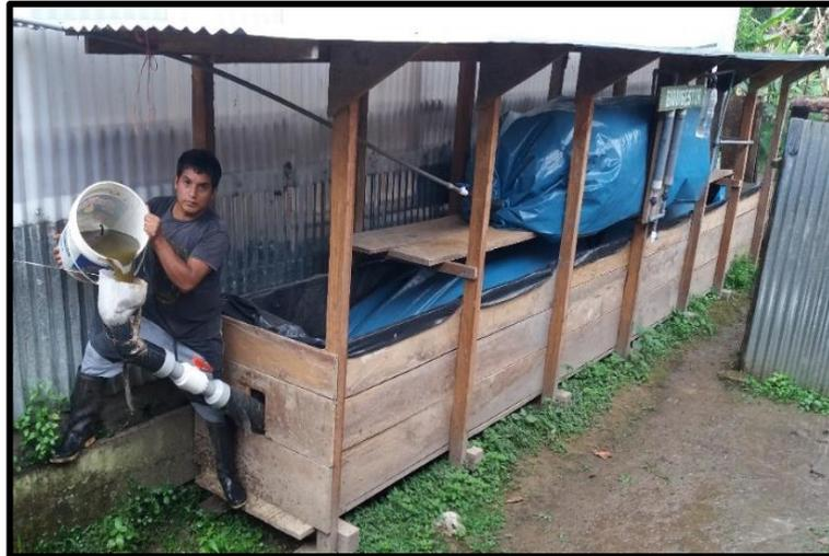
**Figura 16.** Alimentación del biodigestor.
