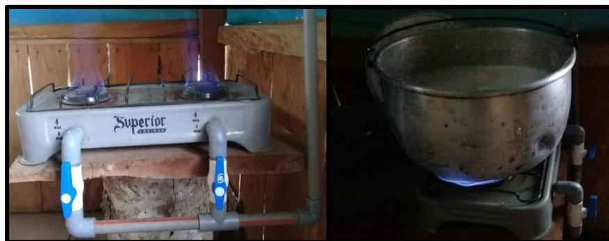
**Figura 22.** Prueba de combustión del biogás en la cocina para preparar leche de soja.
