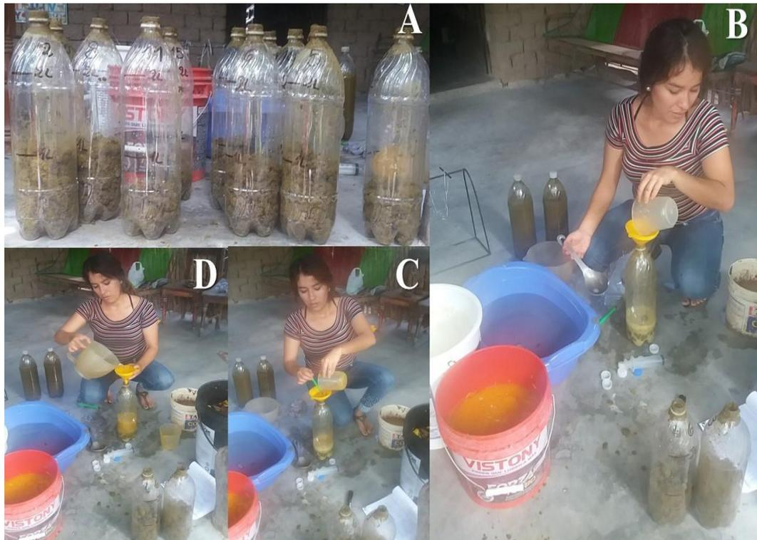
**Figura 5.** Carga de los biodigestores con diferentes concentraciones de residuo orgánico. A) Estiércol de ganado bovino; B) lactosuero; C) cáscara de papaya y D) agua reposada.
