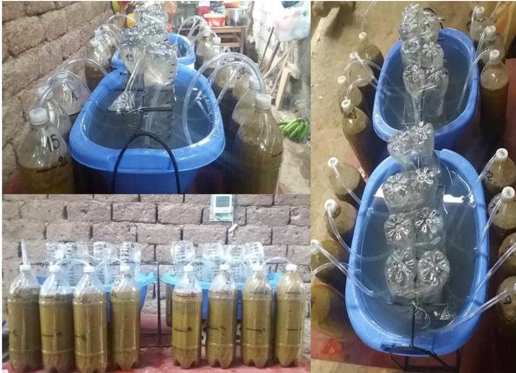
**Figura 6.** Corrida experimental con 15 biodigestores.
