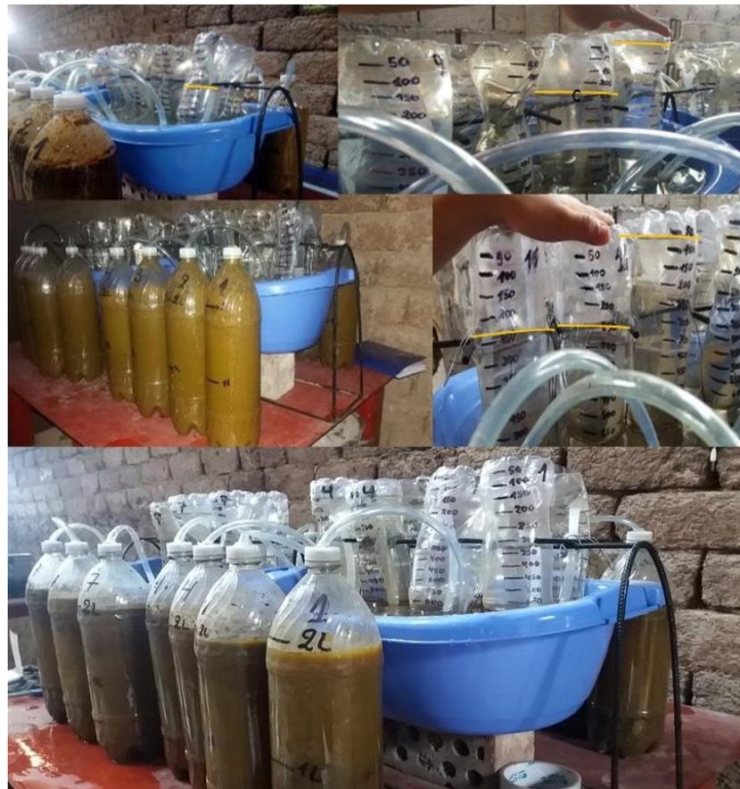
**Figura 9.** Gasómetros con biogás.
