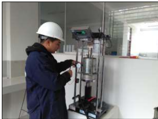
Foto N° 15: Ensayo de C.B.R (calibración)
