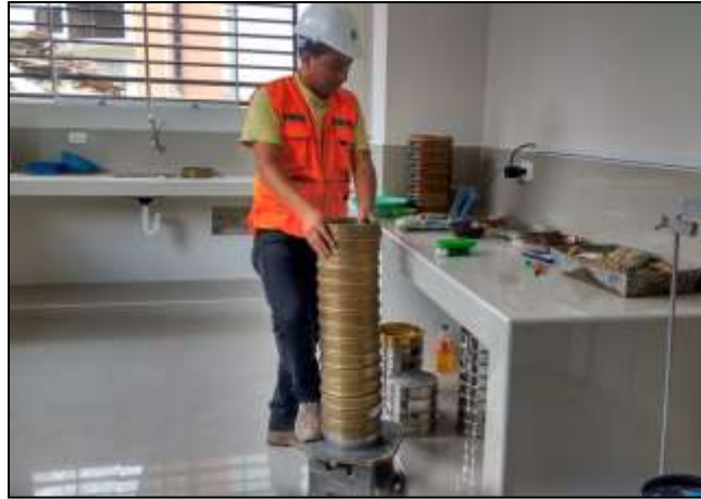
Foto N° 7: Análisis granulométrico manual
