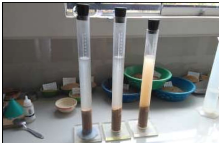
Foto N° 12: Ensayo de expansión del suelo luego de 24 horas
