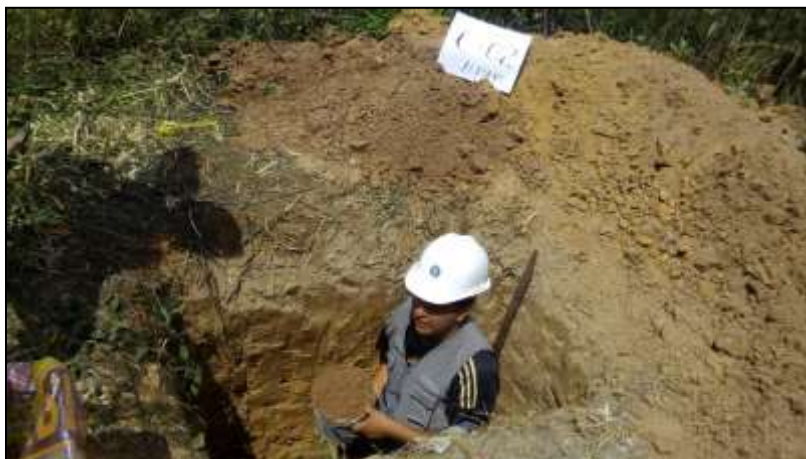
Foto N° 3: Extracción de muestra de calicata
