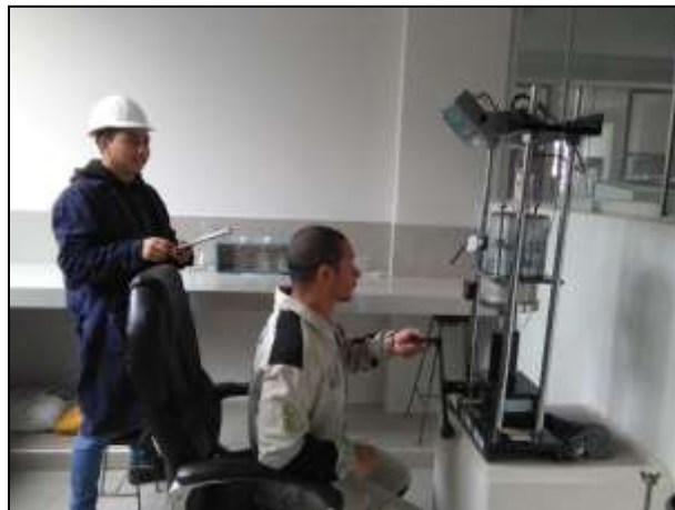
Foto N° 17: Ensayo de C.B.R (toma de datos)
