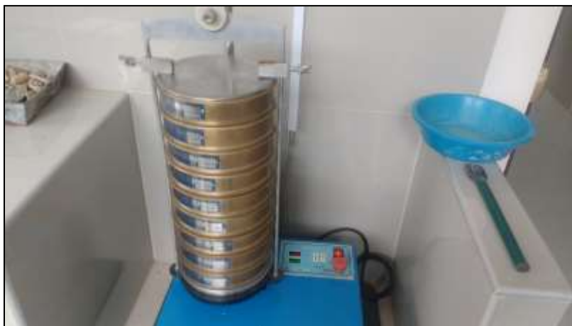
Foto N° 6: Análisis granulométrico en tamizadora
