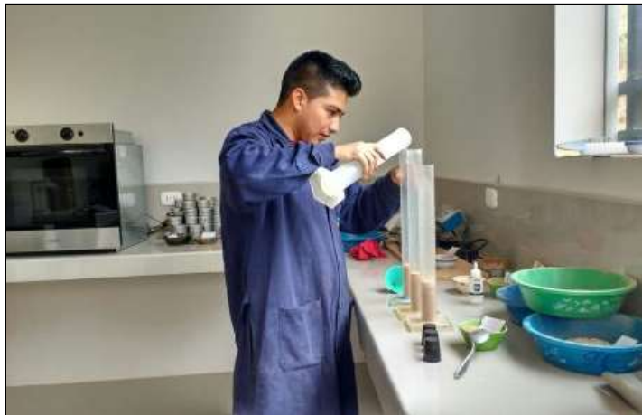
Foto N° 11: Ingreso de agua para el ensayo de expansión del suelo
