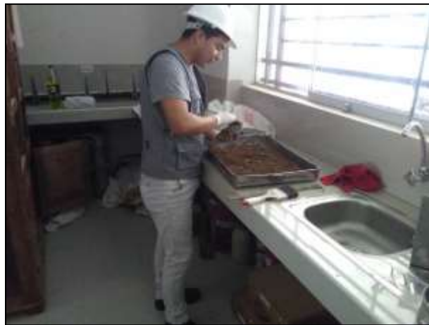
Foto N° 14: Muestra de ensayo de Próctor para contenido de humedad
