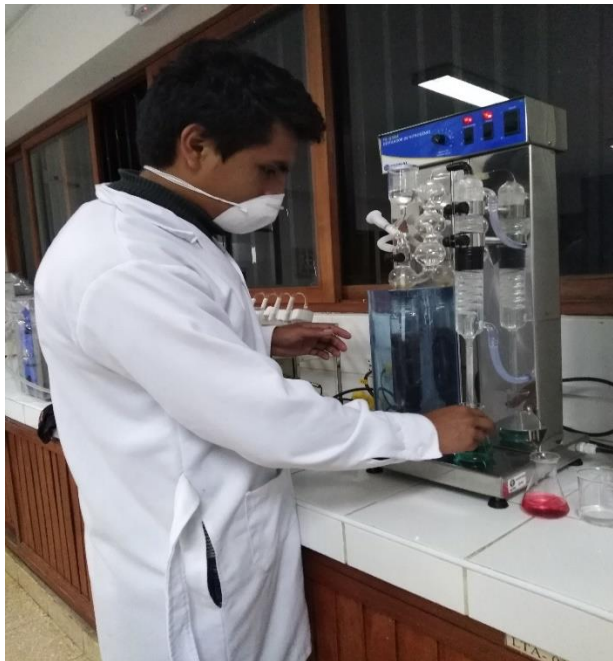
FIGURA 11: Digestión para determinar el porcentaje de proteínas en cada tratamiento.
