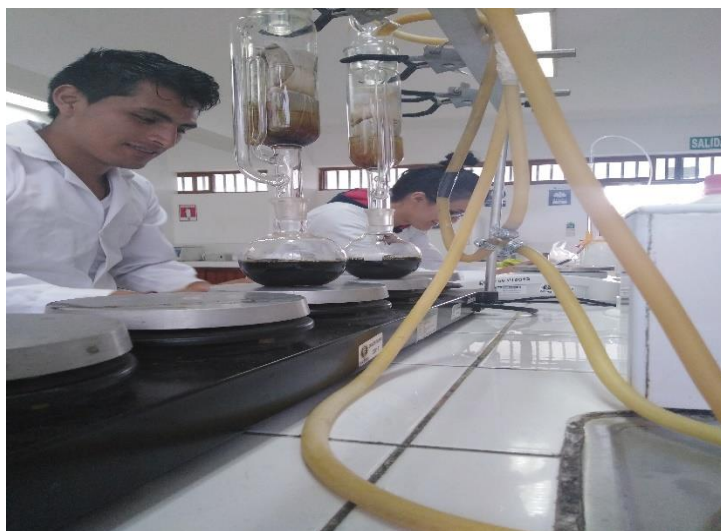
FIGURA 12: Extracción de lípidos en el equipo Soxhlet para determinar el porcentaje de lípidos en cada tratamiento.
