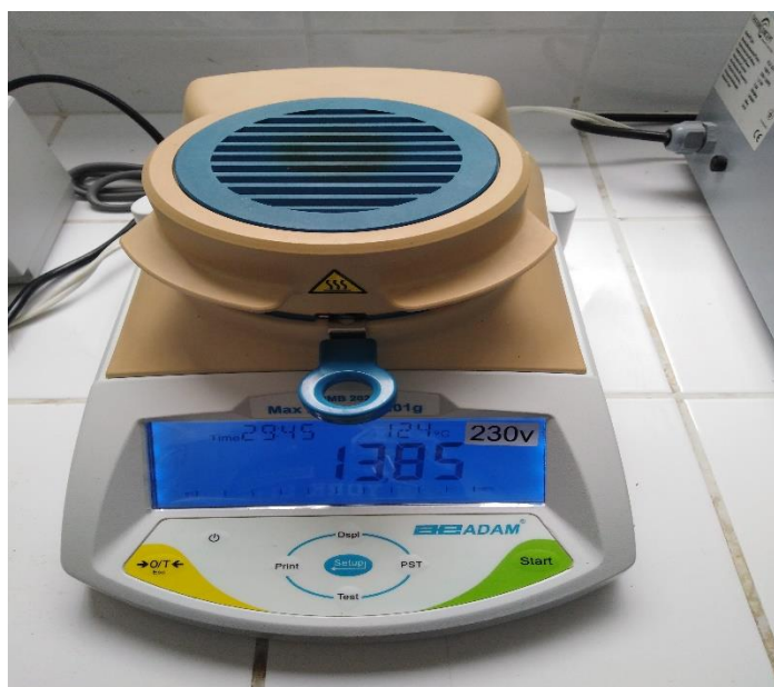
FIGURA 15: Mediciones de humedad en la balanza de humedad para todos los tratamientos de fideo elaborados.
