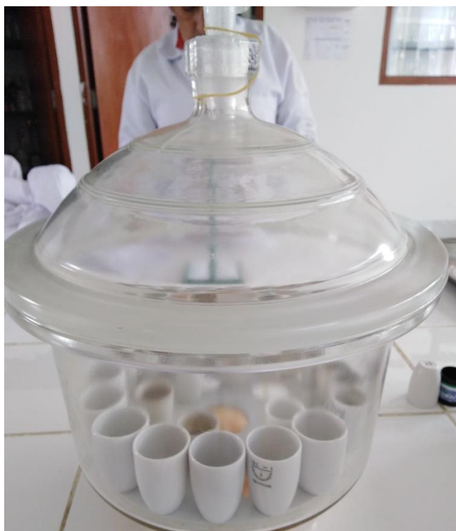
FIGURA 16: Campana de humedad para determinar la cantidad total de cenizas por diferencias de peso.
