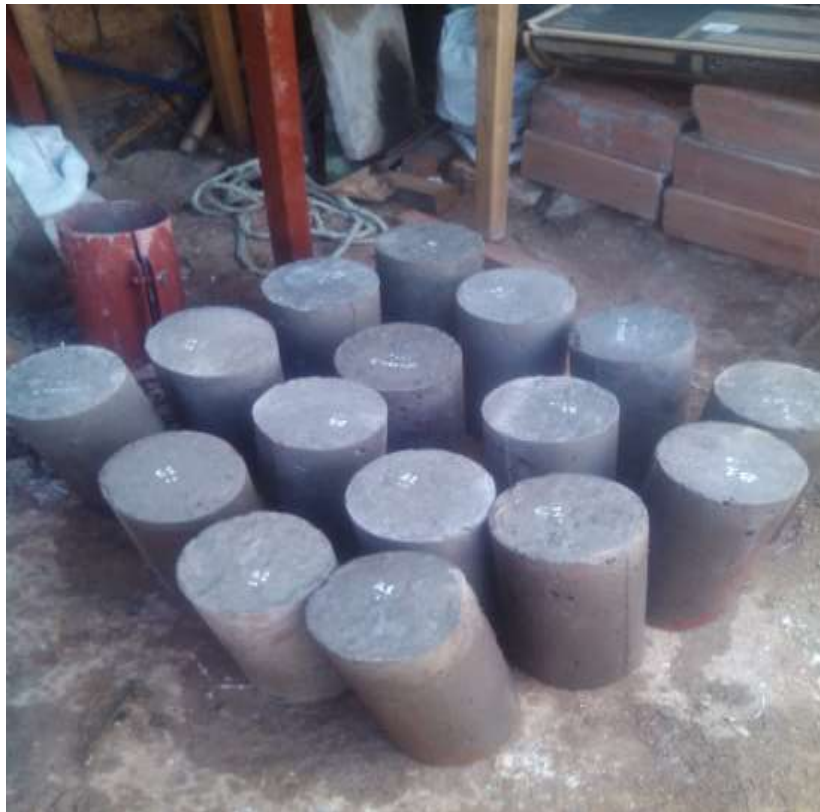
Foto 16: Obtención de testigos de concreto.
