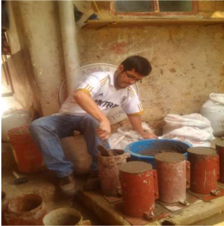
Foto 15: Colocación de concreto en probetas.
