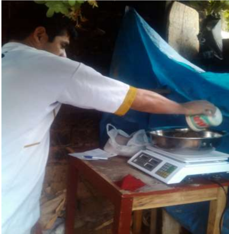
Foto 13: Pesado de agregado fino.
