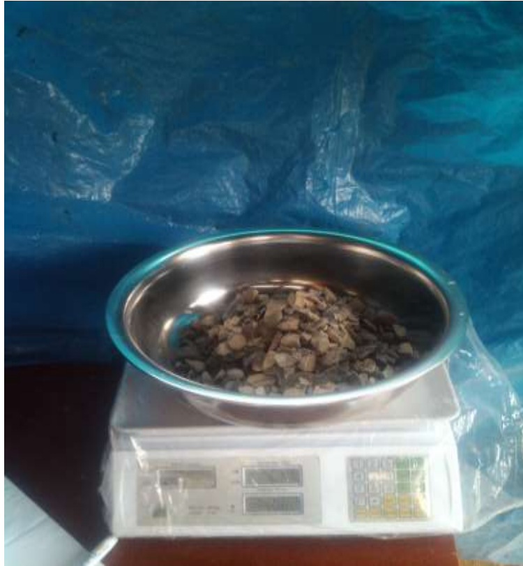
Foto 11: Pesado de agregado grueso
