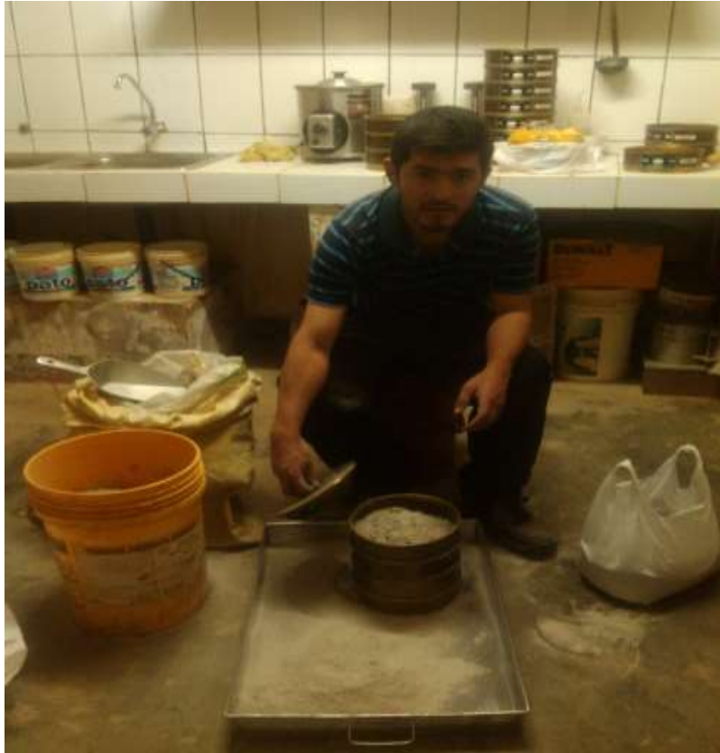
Foto 7: Tamizado de ceniza de cáscara de café
