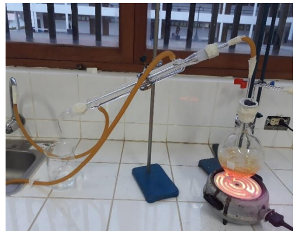
Figura 9. Extracción del aceite esencial
