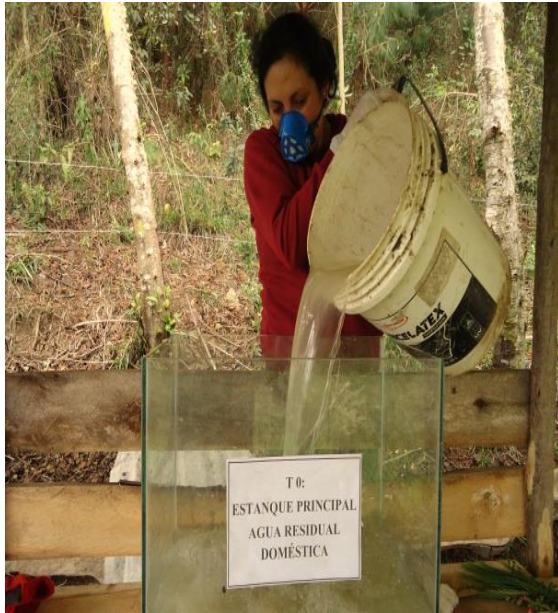
Figura 13. Vaciado del agua residual Doméstica en el estanque principal como tratamiento Testigo.
