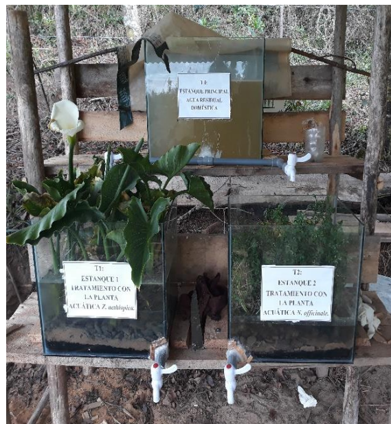
Figura 20. Sistema de tratamiento con las plantas acuáticas Zantedeschia aethiopica y Nasturtium officinale .
