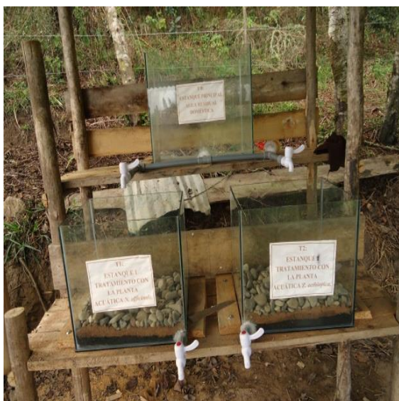
Figura 11. Colocación del filtro: piedra de río, arena y carbón de madera.
