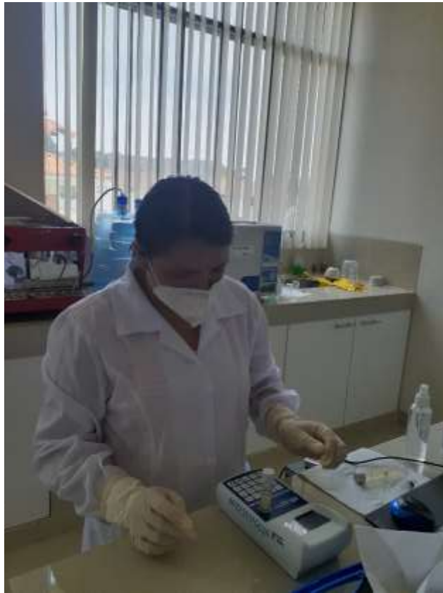
Figura 25. Midiendo la turbidez del líquido de gobierno (agua y sal), de las cinco marcas de conserva de carne de pollo
