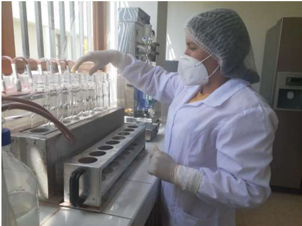
Figura 22. Destilación para determinar proteínas cinco marcas de conserva de carne de pollo
