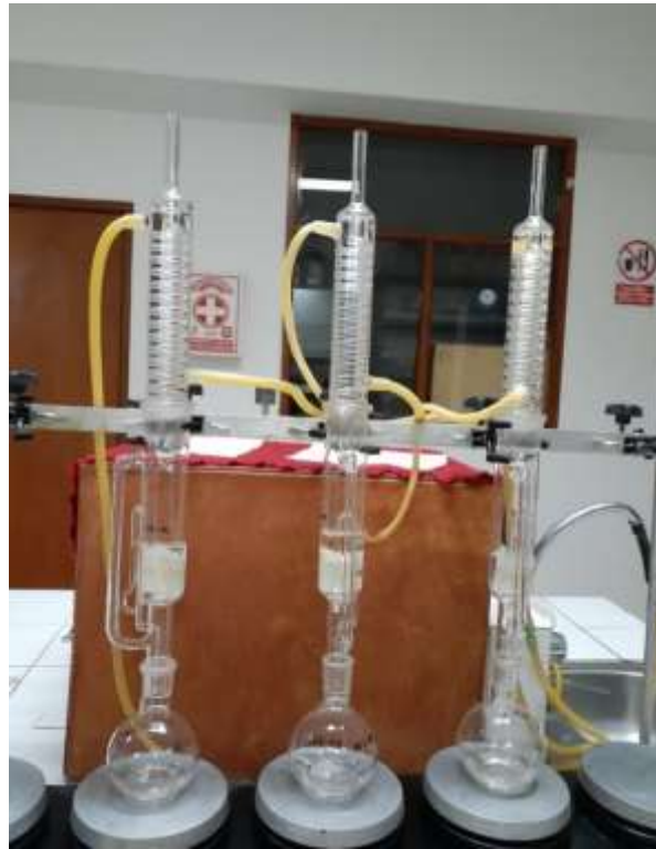
Figura 23. Equipo de soxhlet para encontrar el porcentaje de grasa cinco marcas de conserva de carne de pollo
