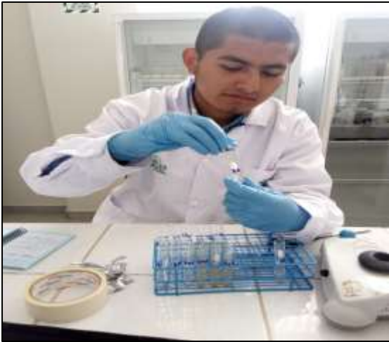
Figura 20: se agrega PhosVer 3 y NitraVer5 para calcular Fosfatos y Nitratos respectivamente
