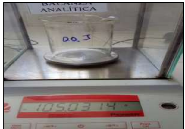
Figura 19. Secado y pesado de vaso precipitado para determinar solidos suspendidos
