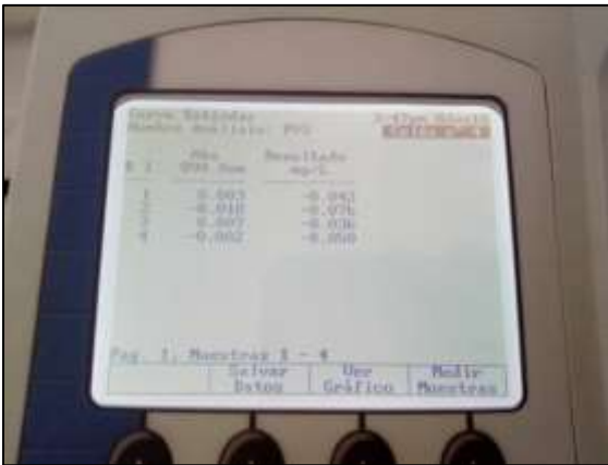
Figura 22: Se lee el resultado de Fosfatos y Nitratos en el fotómetro
