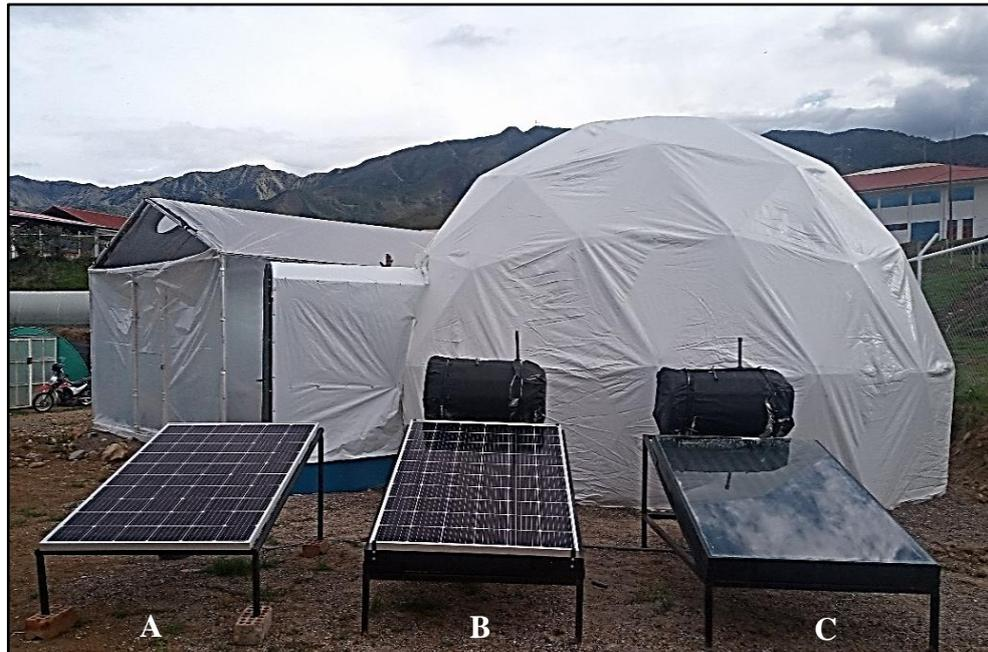
**Figura 13.** (A) panel FV, (B) sistema híbrido fotovoltaico/térmico, (C) sistema solar térmico.
