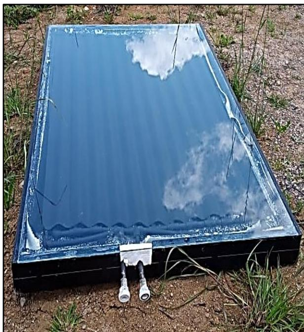
*Figura 11.* Colector solar térmico terminado.
