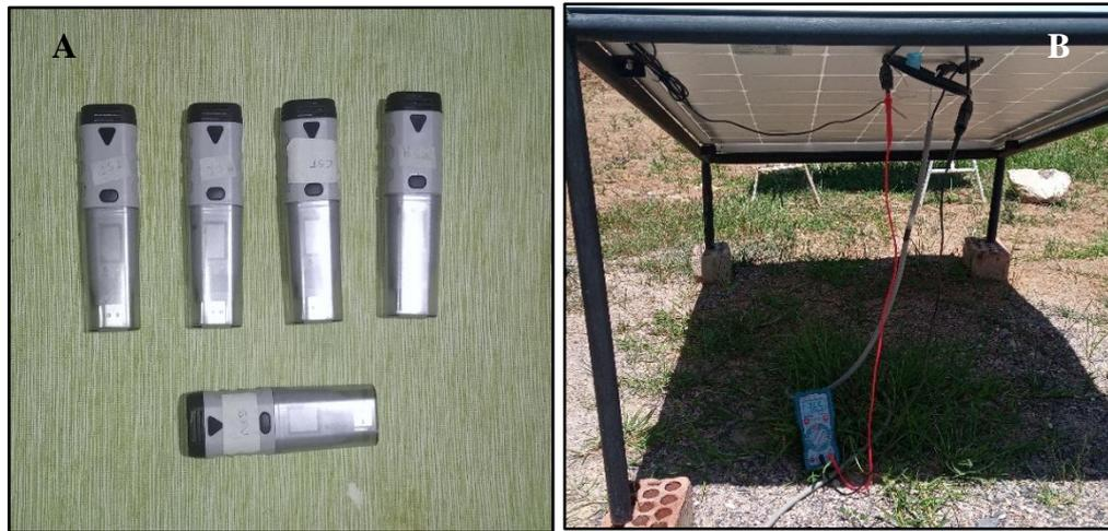
**Figura 14.** (A) data logger, (B) multímetro digital.
