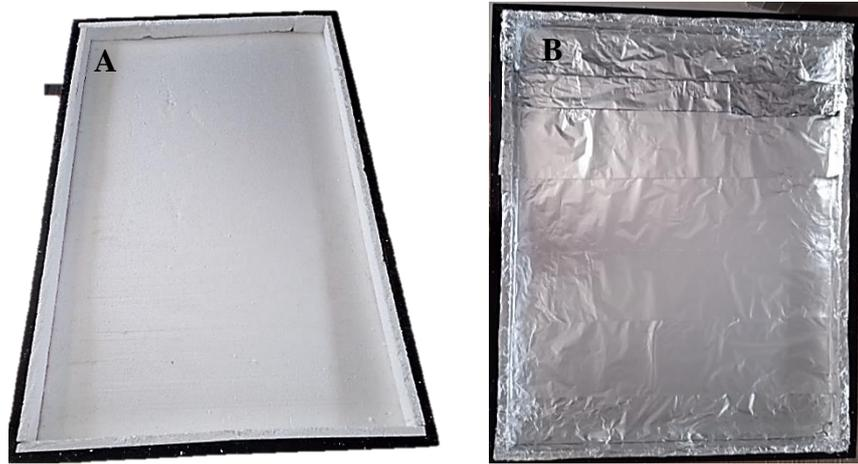
**Figura 4.** (A) forro con tecnopor, (B) forro con papel aluminio.
