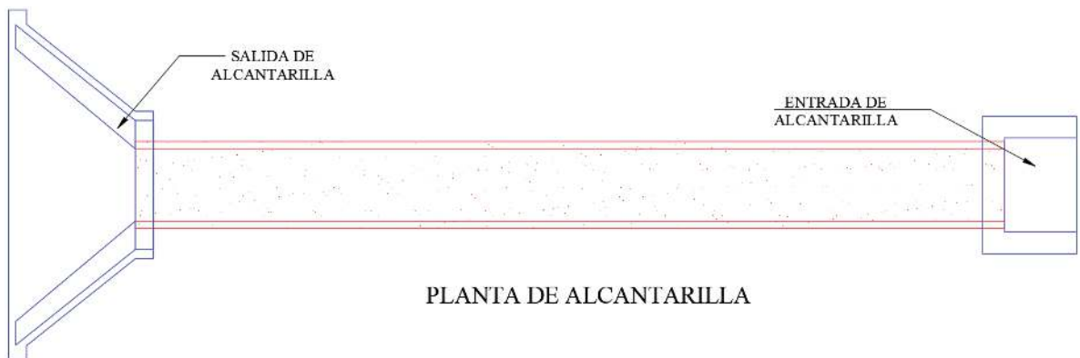
Figura VI. Vista en planta Alcantarilla típica TMC
