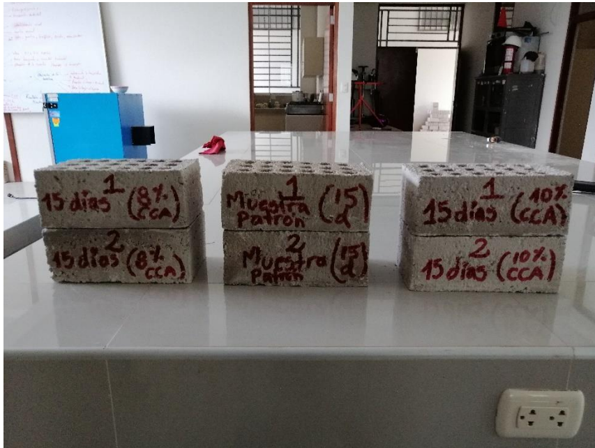
Foto N° 16. Muestras de ladrillos a los 15 días.
