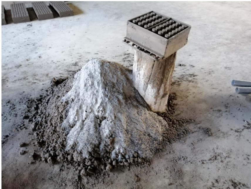
Foto N° 12. Mezcla de concreto con la ceniza de la cascarilla de arroz y molde del ladrillo King Kong de 18 huecos
