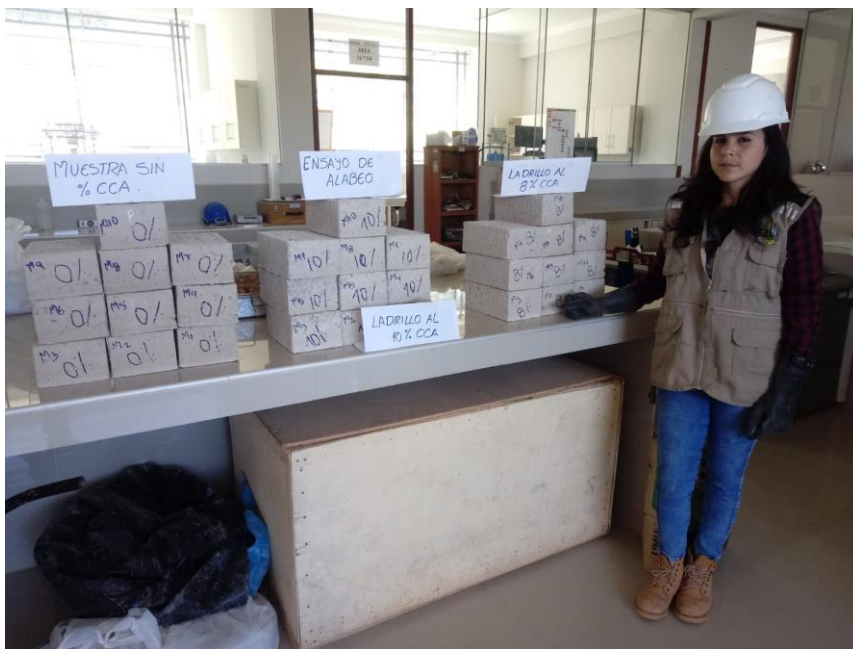
Foto N° 28. Muestras para realizar el ensayo de Alabeo
