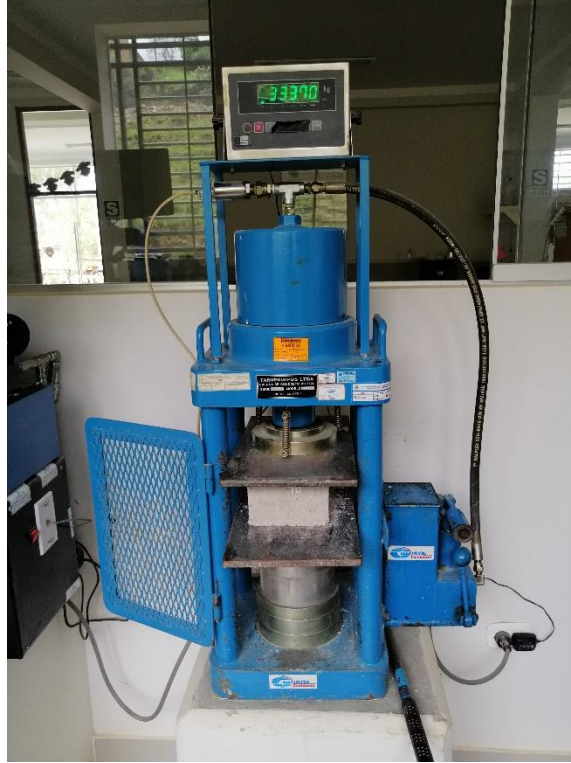
Foto N° 19. Resultado de ensayo de resistencia a la compresión.
