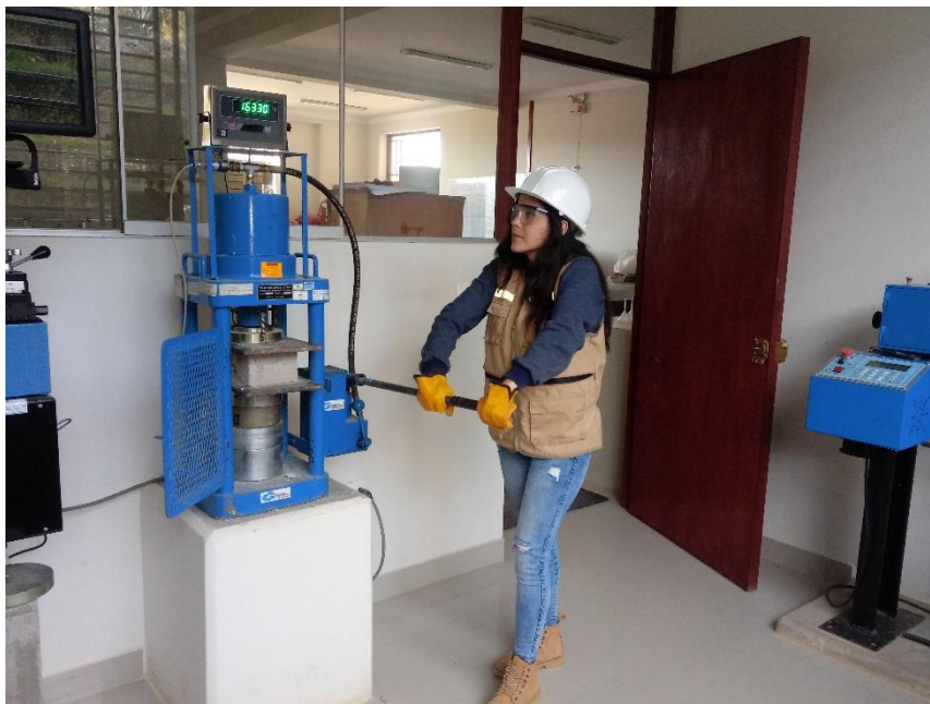
Foto N° 18. Ensayo de resistencia a la compresión.
