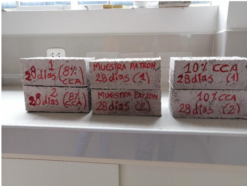
Foto N° 17. Muestras de ladrillos a los 28 días.
