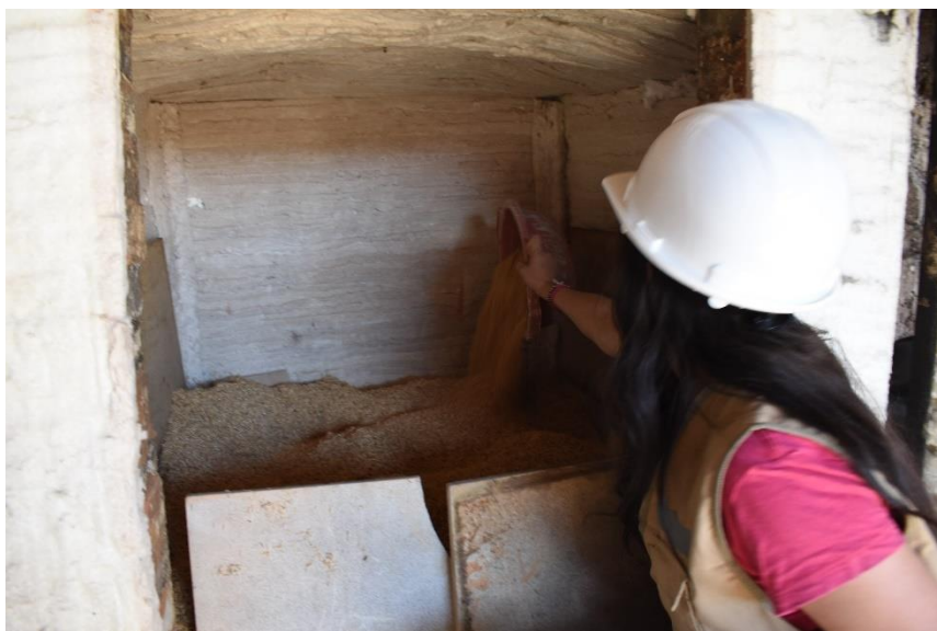
Foto N° 02. Vertiendo la cascarilla de arroz en un horno industrial para el tratamiento térmico.
