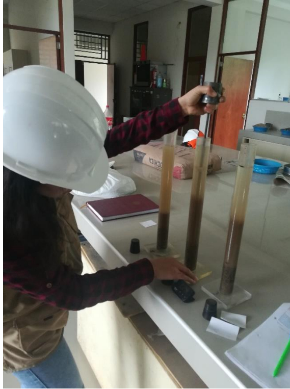
Foto N° 09. Ensayo de equivalente de arena.
