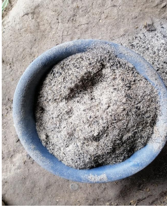
Foto N° 05. Producto del tratamiento térmico sometido a la cascarilla de arroz (ceniza de la cascarilla de arroz).
