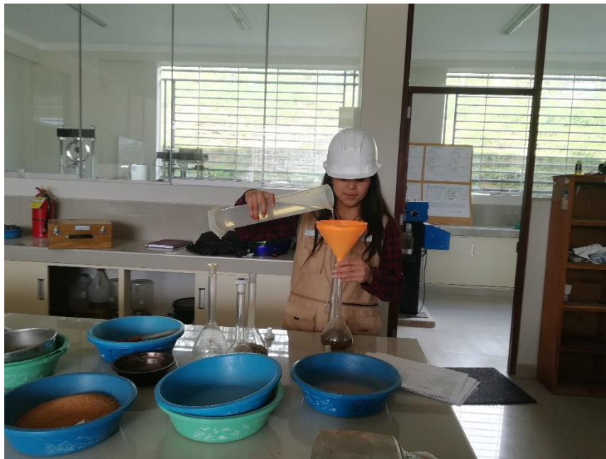
Foto N° 10. Ensayo de peso específico con fiolas para arenas
