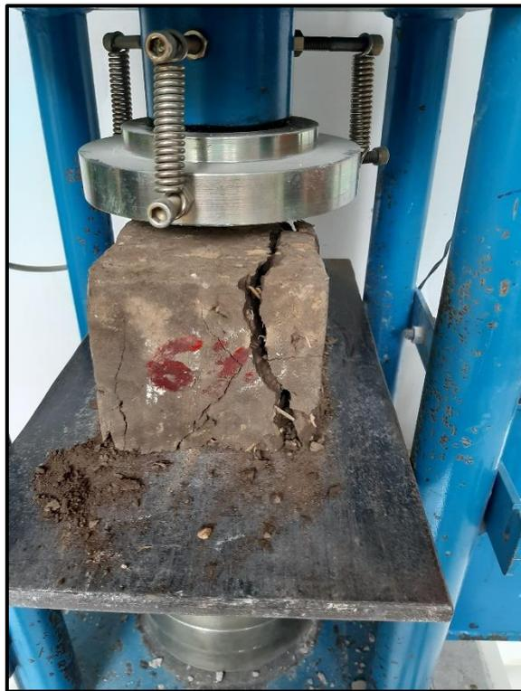
Figura 18. Ensayo de resistencia a la compresión de los cubos de adobe.
