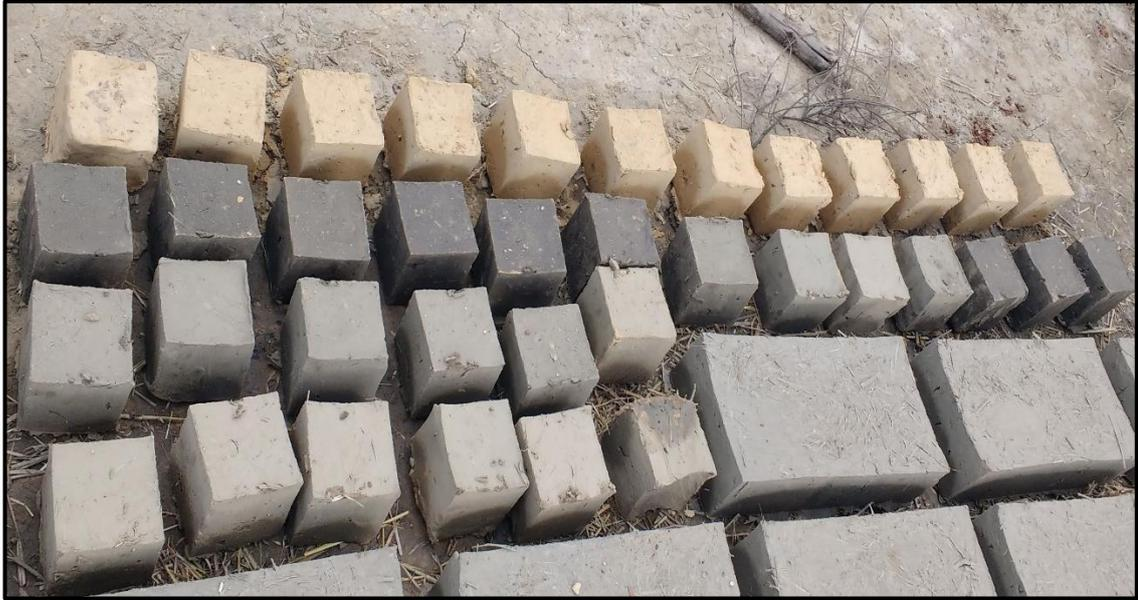
Figura 13. muestras de adobe para ensayo de compresión.
