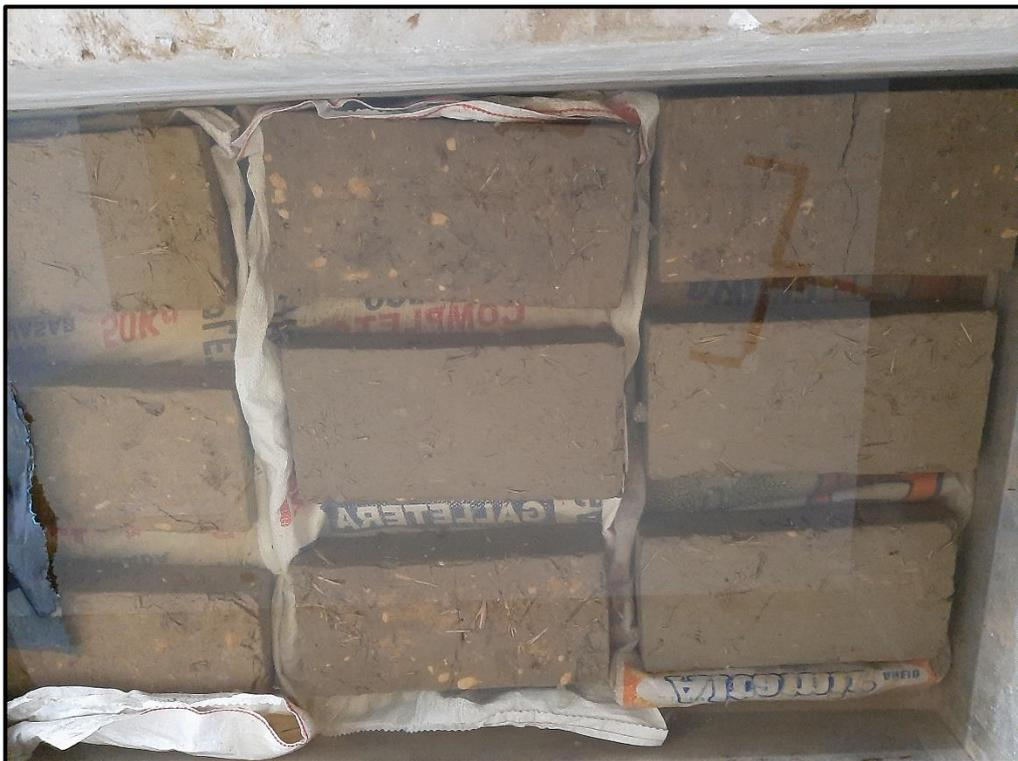
Figura 22. Muestras de adobe con adición de asfalto después de 24 horas de saturación
