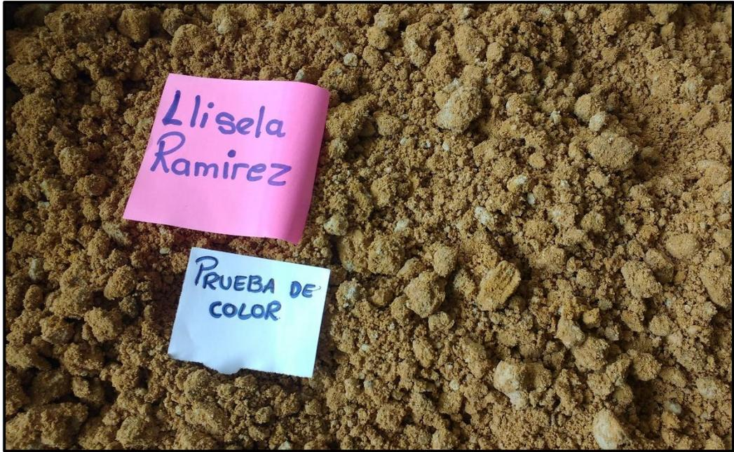
Figura 9. Prueba de color para seleccionar suelo apto para adobes
