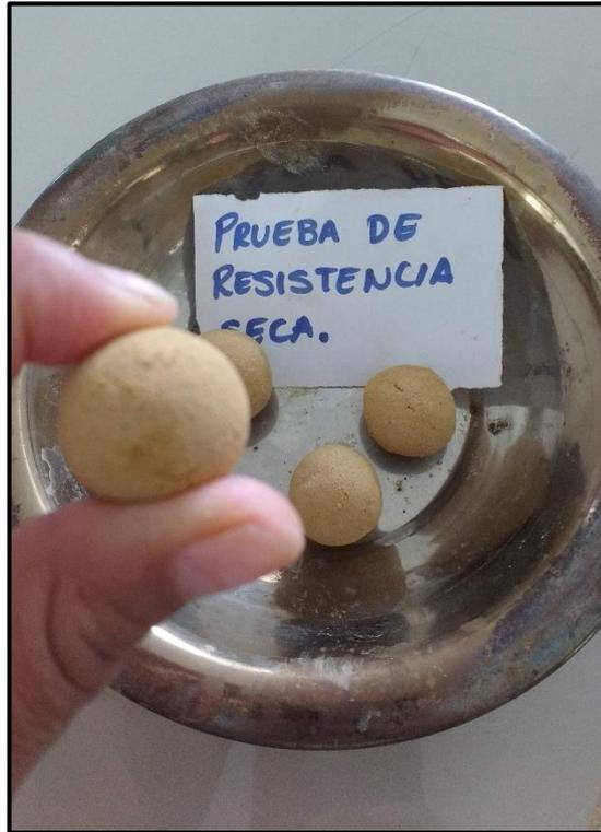
Figura 5. Prueba a la Resistencia para seleccionar un suelo apto para elaboración de adobe.
