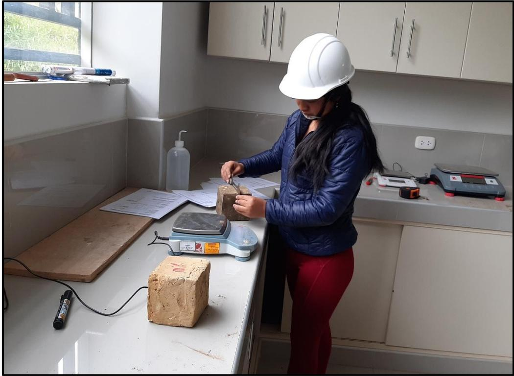
Figura 17. Registro de dimensiones y peso de los adobes para ensayo de resistencia a la compresión
