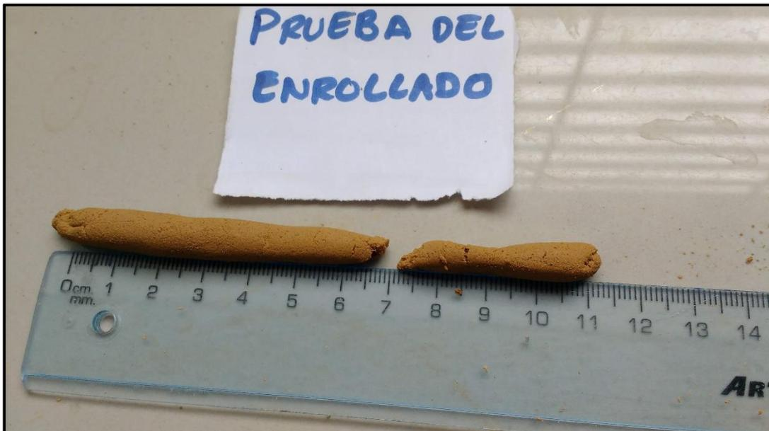
Figura 6. Prueba del enrollado para selección de suelo apto para elaboración de adobe
