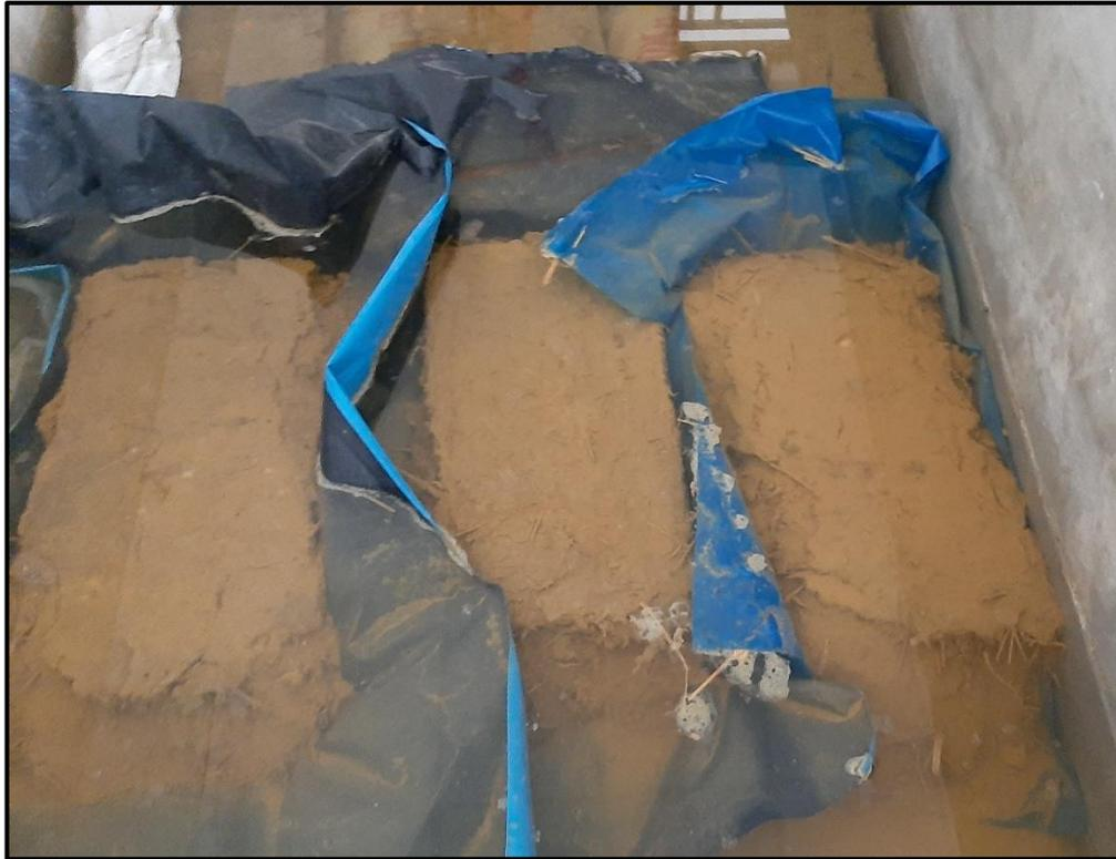
Figura 21. Muestras de adobe tradicional después de 24 horas de saturación.
