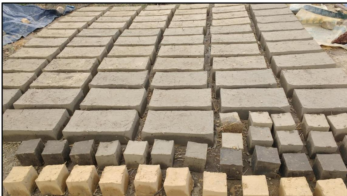
Figura 12. Muestras de adobes en proceso de secado.
