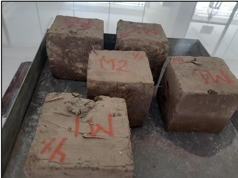
Figura 26. Muestras de adobe después de haber sido secados en el horno, ensayos de saturación total.
