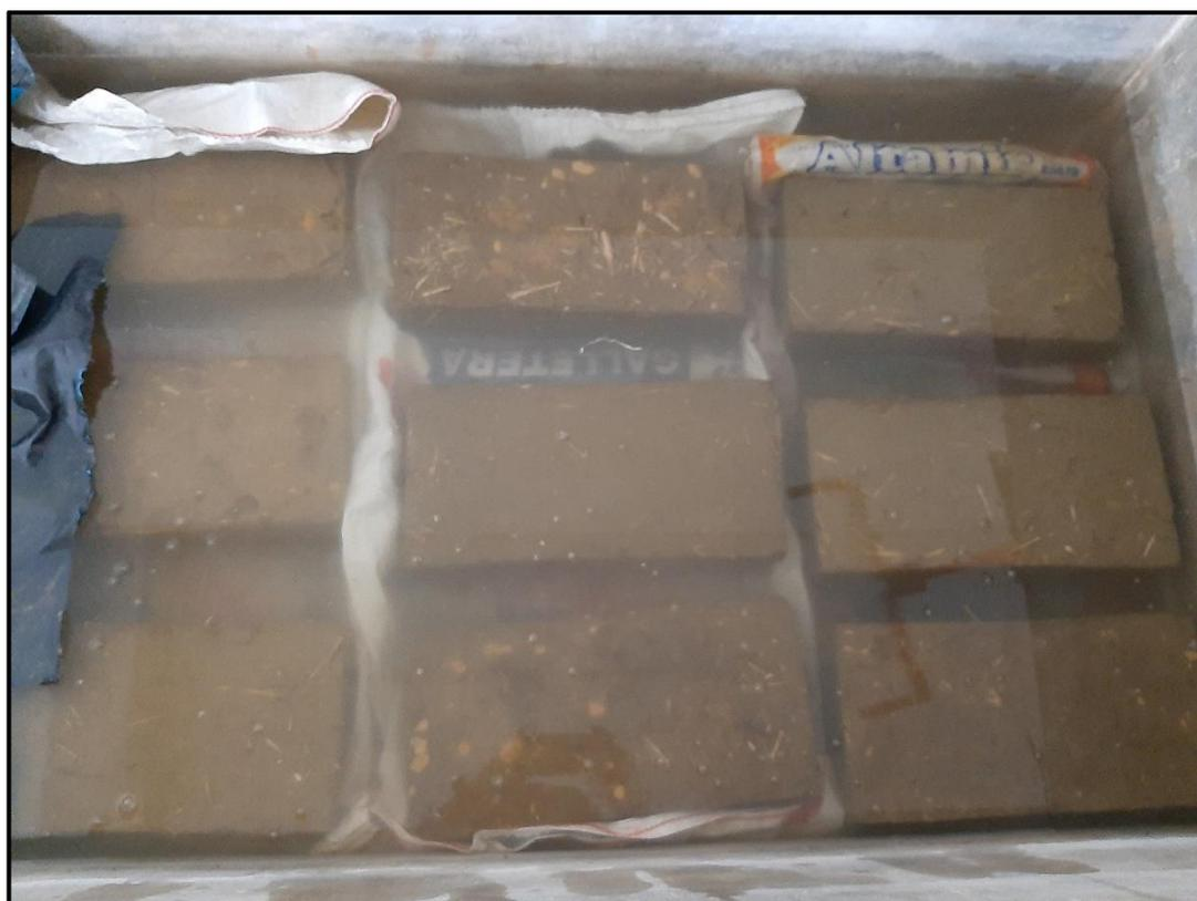
Figura 20. Muestras de adobe sumergidos a agua para ensayo de absorción.
