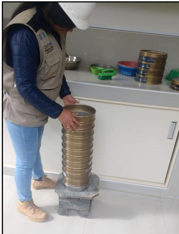
Figura 8. Ensayo de Análisis Granulométrico del suelo seleccionado.
