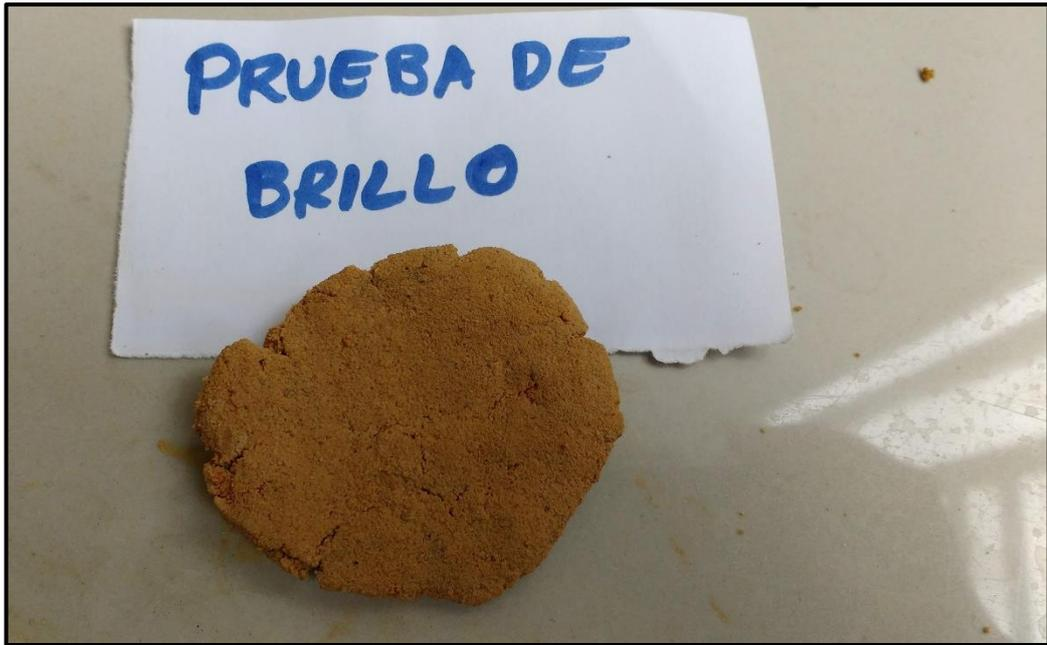
Figura 7. Prueba de brillo para seleccionar un suelo apto para la elaboración de adobe.
