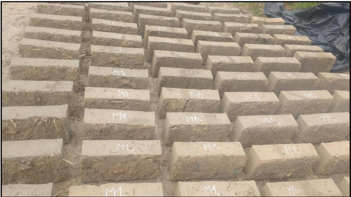
Figura 14. Colocación del adobe tradicional de canto para que complete su secado.
