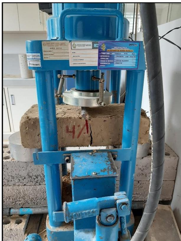
Figura 19. Ensayo de resistencia a flexión de las muestras de adobe.
