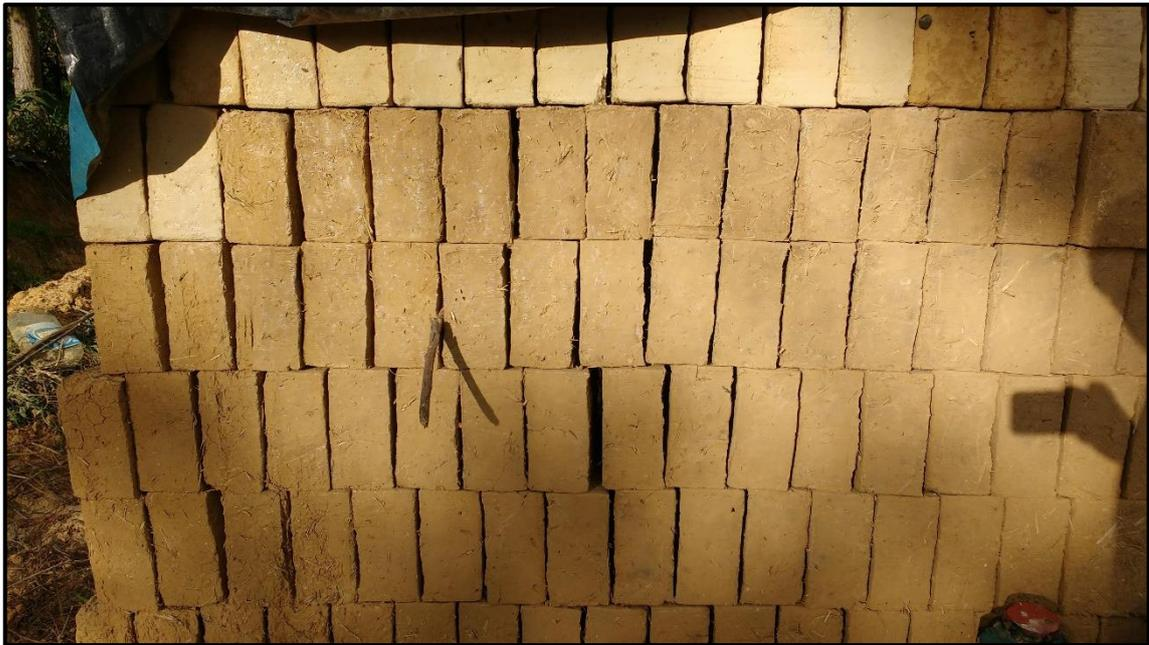
Figura 16. Apilado de los adobes para luego ser transportado al laboratorio.
