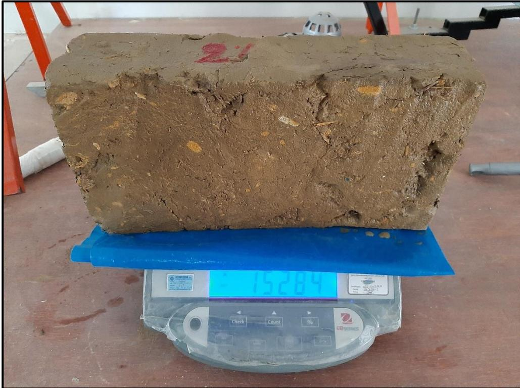
Figura 23. Pesado de las muestras de adobe saturados para calcular el porcentaje de absorción.
