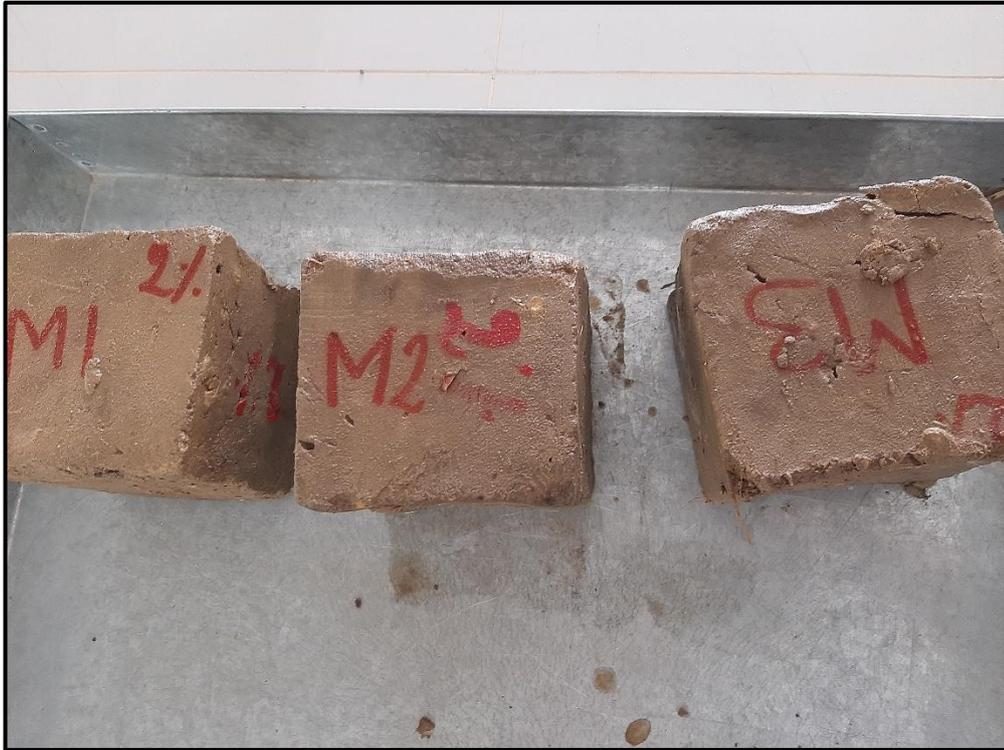
Figura 25. Muestras de adobe después de 24 horas de saturación, listos para ser metidos al horno para ensayo de saturación total.
