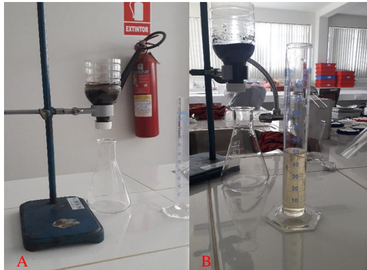
Figura 3. Instalación y prueba de saturación del sustrato artificial (A y B)
