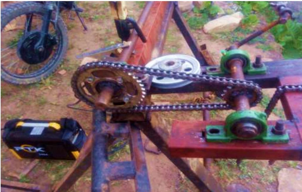
**Fotografía 4:** mecanismo de transmisión.
