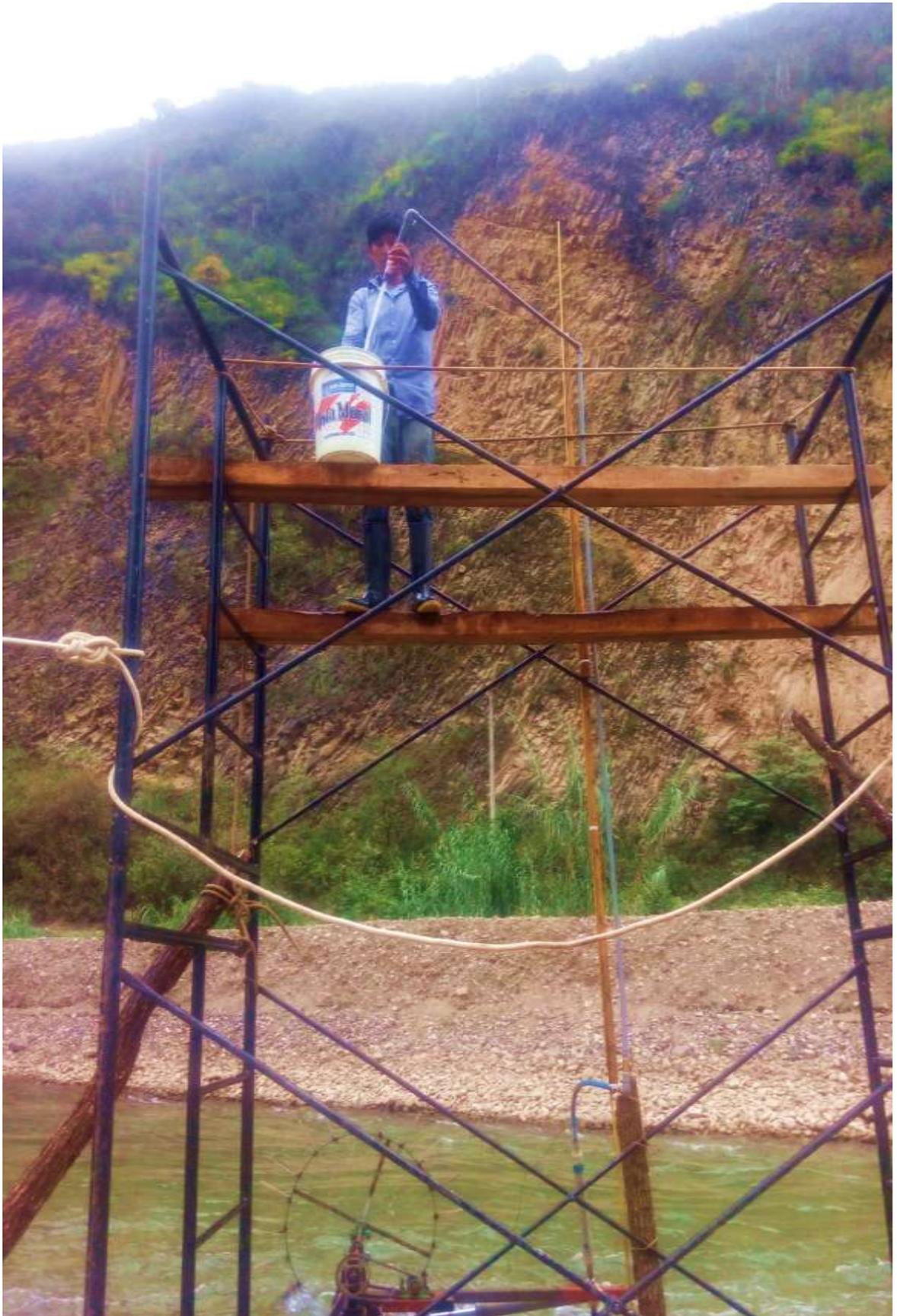
**Fotografía 9:** medición del caudal y altura
