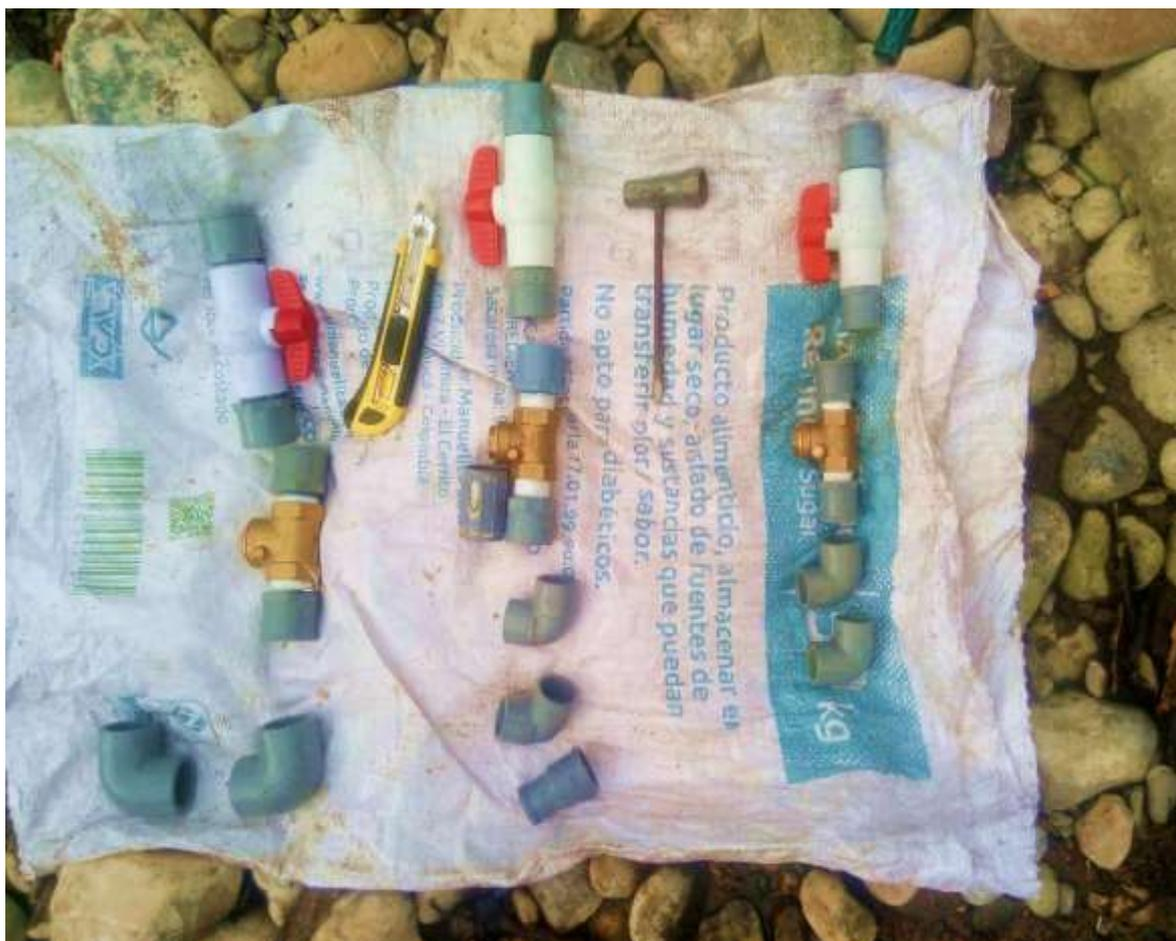
**Fotografía 1.** Se muestra los codos, válvulas de chep y llaves de paso usadas.
