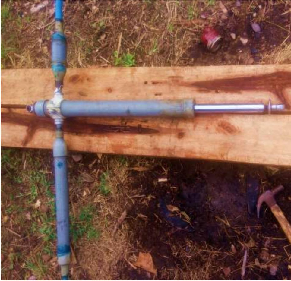
**Fotografía 3:** bomba hidráulica (succión y expulsión del agua).
