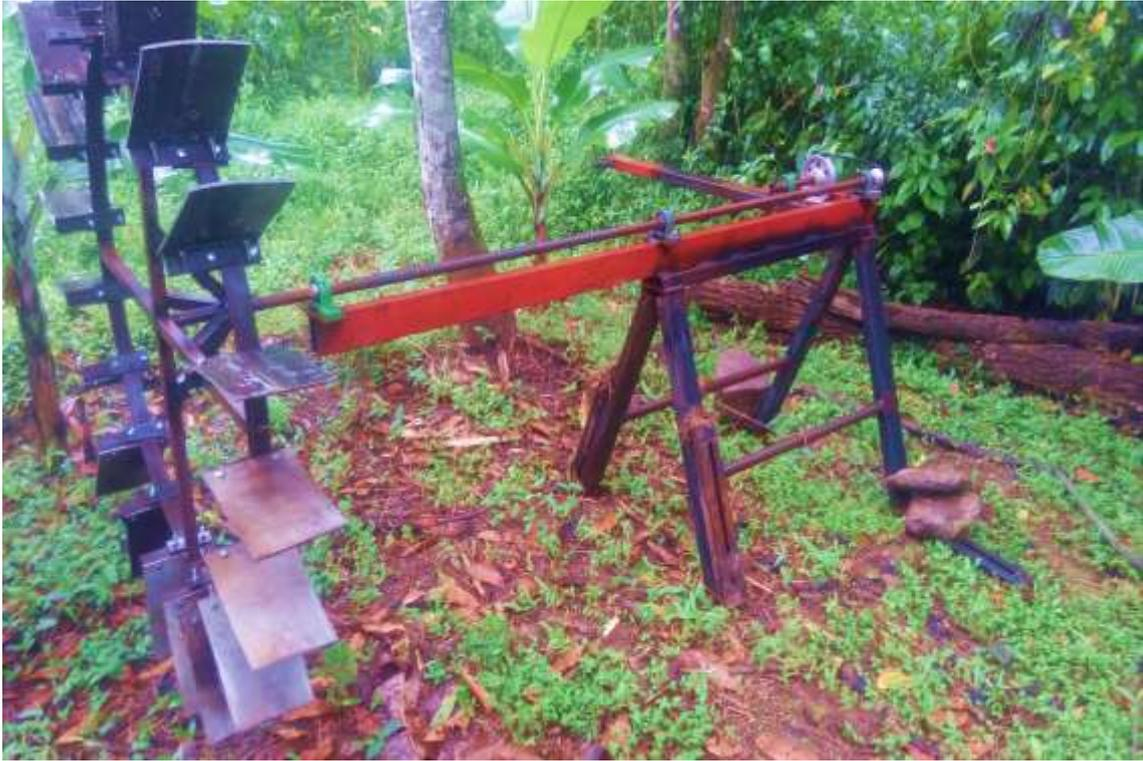
**Fotografía 5:** estructura de la volante hidráulica y el soporte de la bomba.
