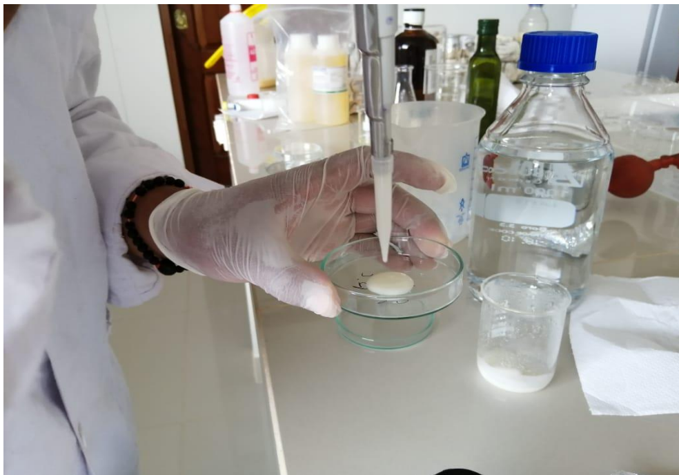
Desarrollo de recubrimiento comestible en placa Petri con 3ml de formulación para llevar a secado
