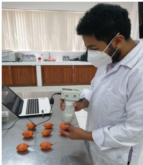
Lectura del color de muestras de tomate de árbol a lo largo del almacenamiento
