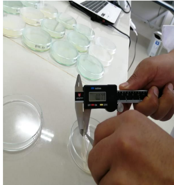
Lectura del espesor de los recubrimientos con vernier digital
