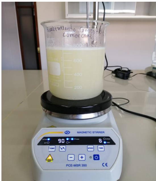
Elaboración de recubrimiento comestible en agitador magnético
