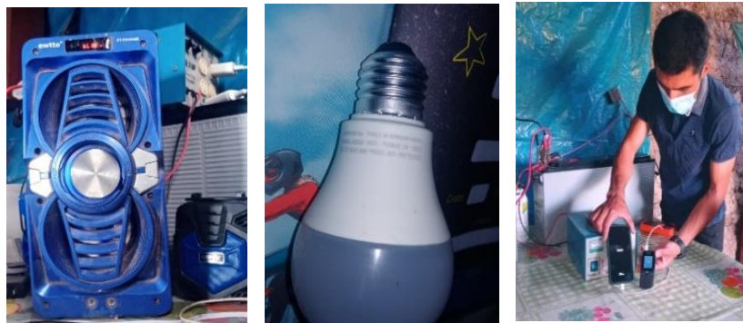
Figura 14. Foco LED de 12 W, teléfono celular 40 W y radio grabadora de 30 W.
