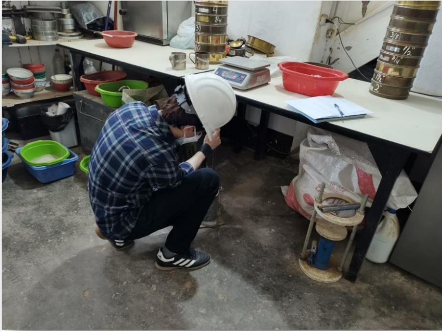
**FOTO 3.** Compactando por varillado el agregado grueso.
