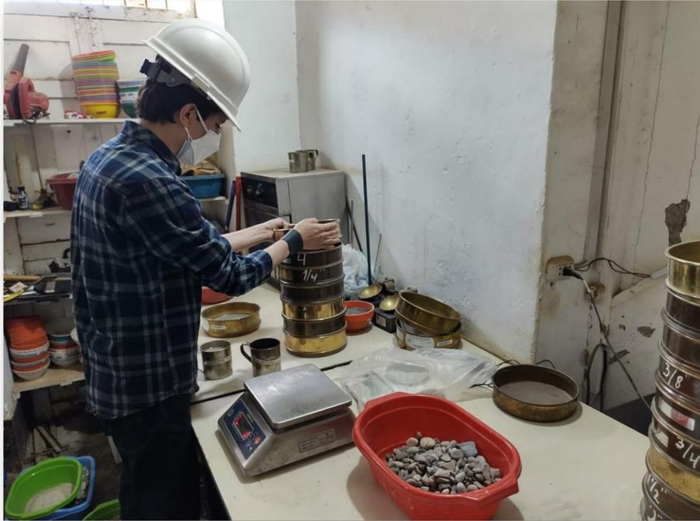
**FOTO 7.** Tamizado del agregado grueso.
