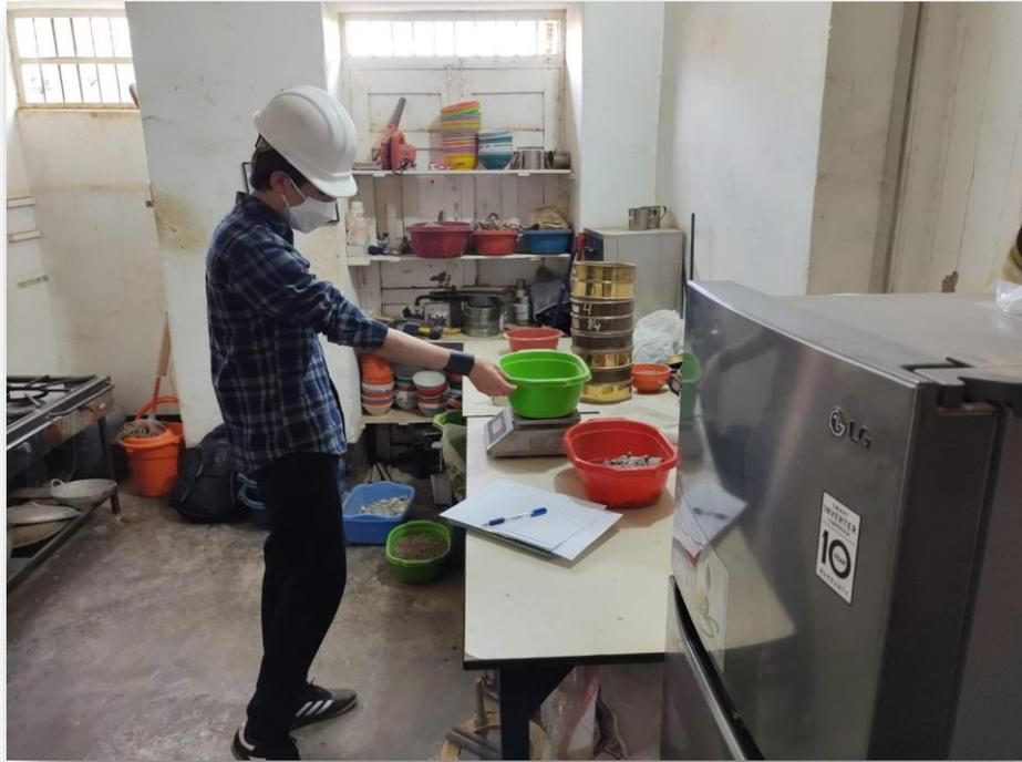
**FOTO 1.** Pesando el agregado fino.
