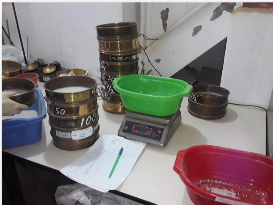
**FOTO 6.** Tamizado del agregado fino.
