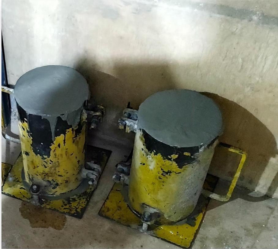
**FOTO 9.** Elaboración de los testigos de concreto.
