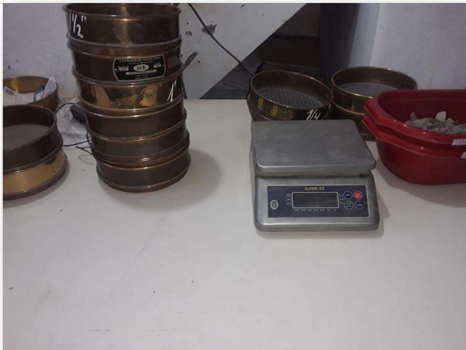
**FOTO 2.** Tamices y balanza electrónica usadas para los ensayos mecánicos de los agregados.
