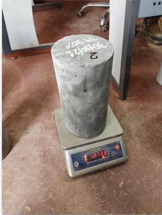
**FOTO 11.** Pesando el testigo de concreto previa prueba de la resistencia a la compresión.
