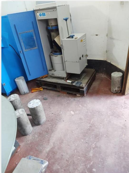
**FOTO 12.** Prueba de la resistencia a la compresión de los testigos de concreto.
