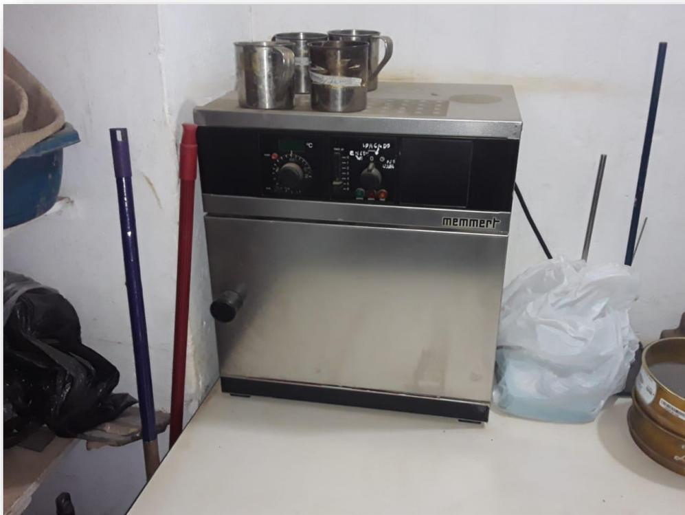
**FOTO 8.** Horno utilizado para el ensayo de contenido de humedad de los agregados.
