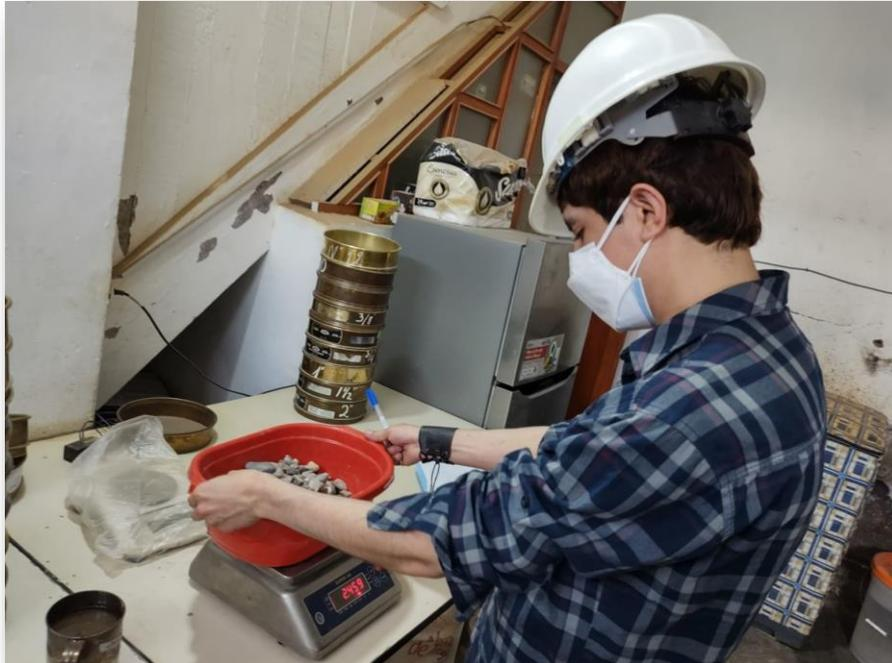
**FOTO 4.** Pesando el agregado grueso.
