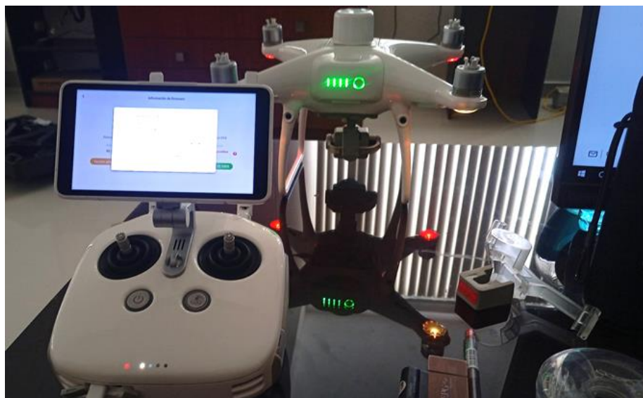
Descarga de datos fotogramétricos (Plan de vuelo_Tesis). Equipo Phantom4RTK
