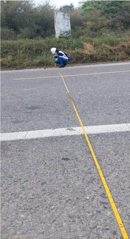
**Figura 19.** *Medida de la longitud del daño - grieta de borde*
