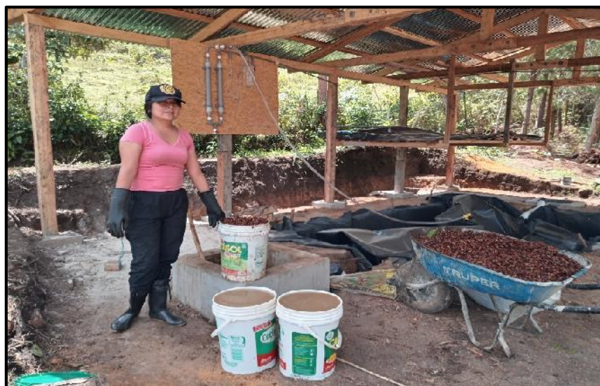
Figura 9. Llenado del Biodigestor con los principales sustratos
