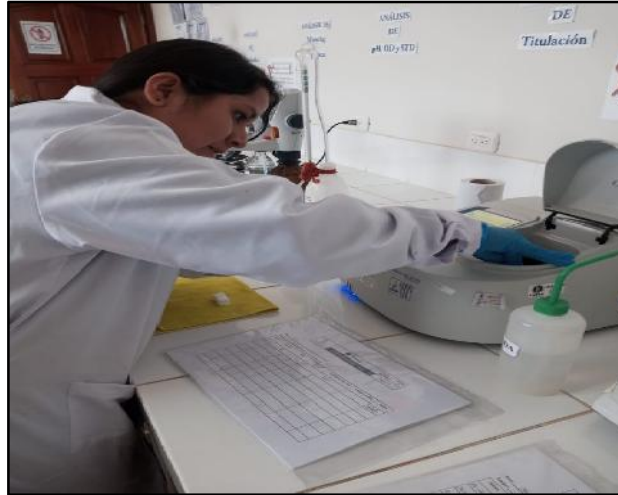
Figura 13. Determinación de DQO en laboratorio
