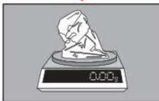
**4** Pesar o pipetear el producto alimenticio en un contenedor estéril adecuado, como una bolsa tipo Stomacher, frasco de dilución, bolsa Whirl-Pak®, o cualquier otro contenedor estéril.
