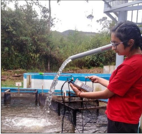
Fotografía 7. Monitoreo de la calidad del agua (temperatura, pH y oxígeno disuelto), con un medidor multiparámetro.
