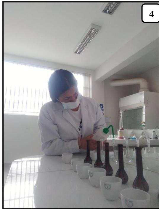
*Nota: 1. Nos muestra la molienda de las muestras de café., 2. Para la extracción de la muestra: Se pesó 1 gramo de cada una de las muestras molidas., 3. Filtrando las muestras de café 4. Como último paso para la extracción de muestras se aforo las fiolas con agua destilada quedando así listas para correr el análisis de metales pesados.*
