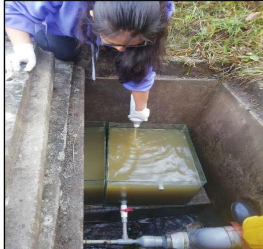
**Figura 17.** Aplicación de la concentración 1 a las aguas residuales
