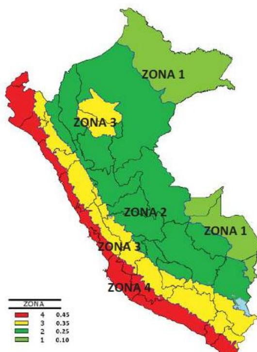
Figura 14. Zonas sísmicas (basado en la NTP E.030,2018).
