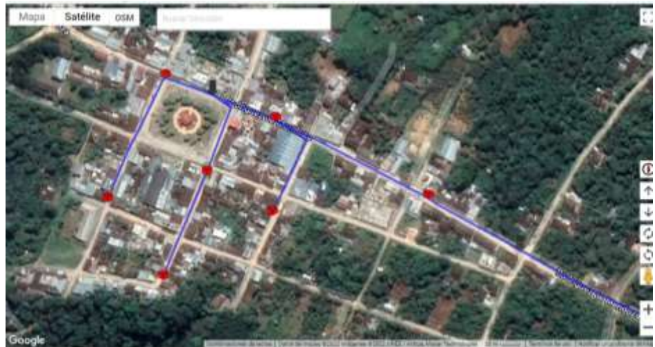
Figura 10. Diseño de la distribución de las cajas NAP
