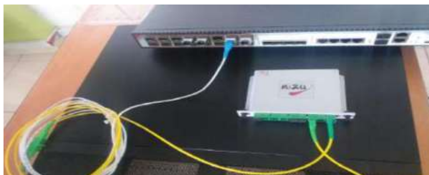
Figura 29. Conexión de OLT al splitter primer nivel
