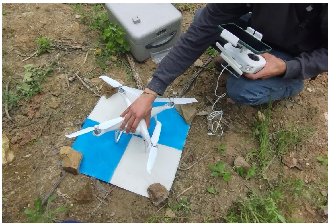
Fotografía 2: Levantamiento fotogramétrico del área de influencia de la quebrada Guichmal.
