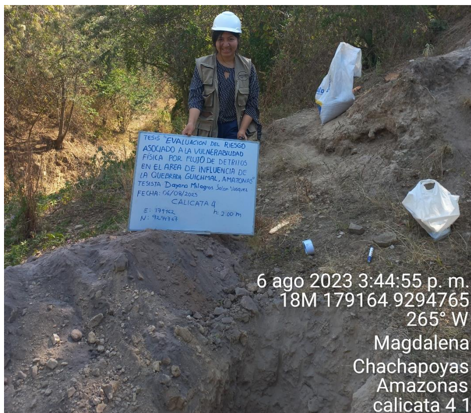
Fotografía 7: Excavación de la calicata 4 y extracción de la muestra.
