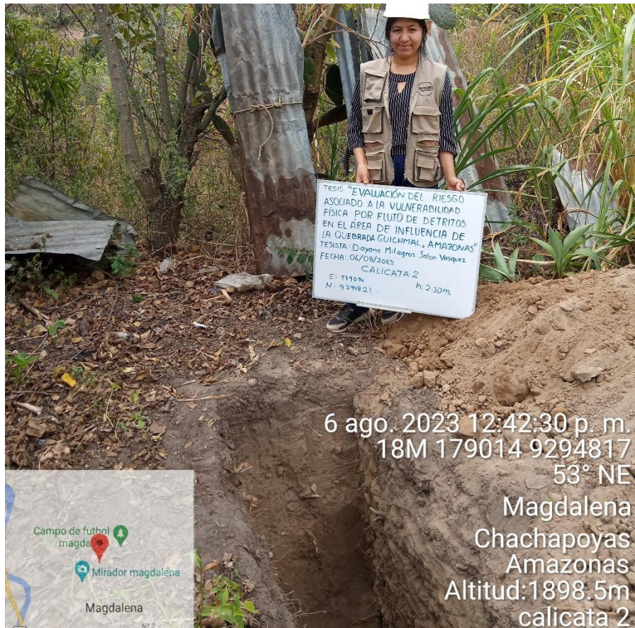
Fotografía 5: Excavación de la calicata 2 y extracción de la muestra.
