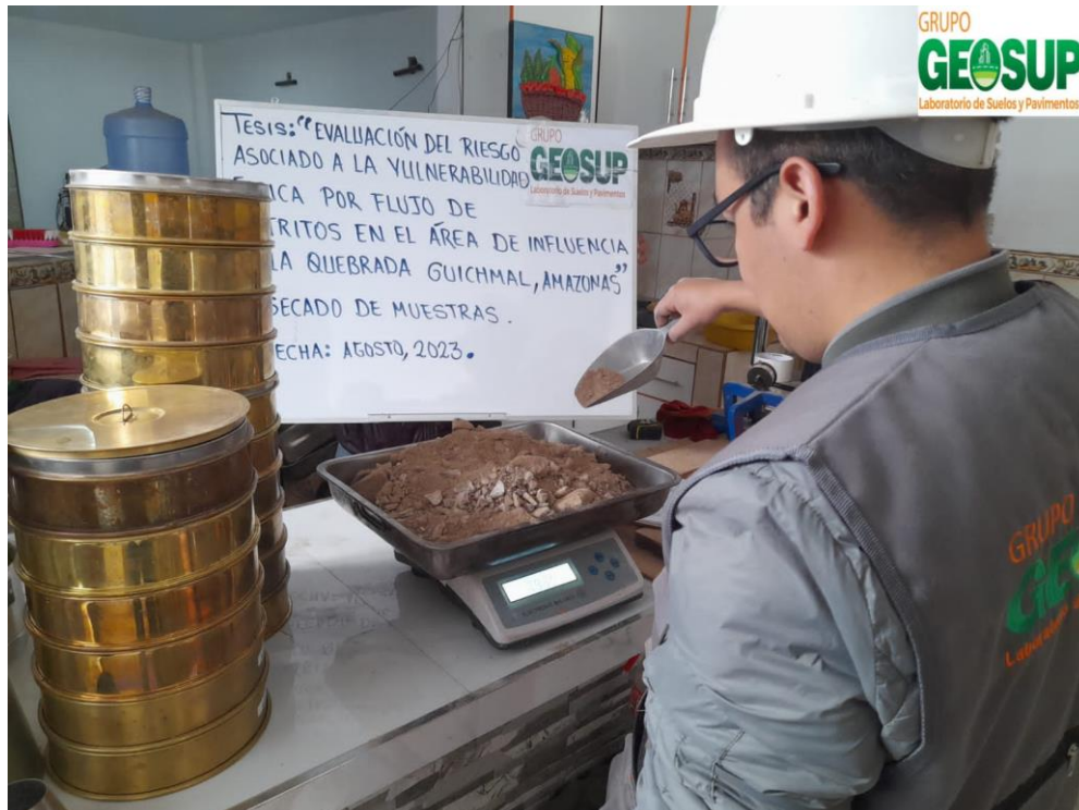
Fotografía 9: Análisis granulométrico de las muestras
