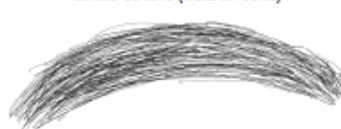
Plancha de ichu (vista en corte)
