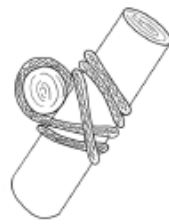
Conexión de tijeral principal con la contravara
